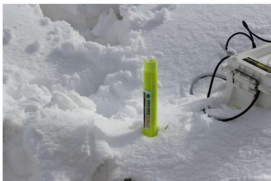
Figura 5.9 Involucro intatto della cartuccia di GBT successivamente all'esplosione (Gorret E., 2014)
