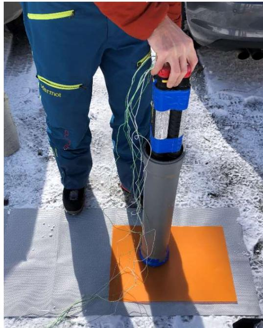
*Figura 5.15 Collocamento delle 4 cariche di Autostem all'interno del tubo di plastica*
