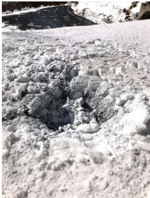
*Figura 5.20* Cratere generato dalla seconda prova con SNP
