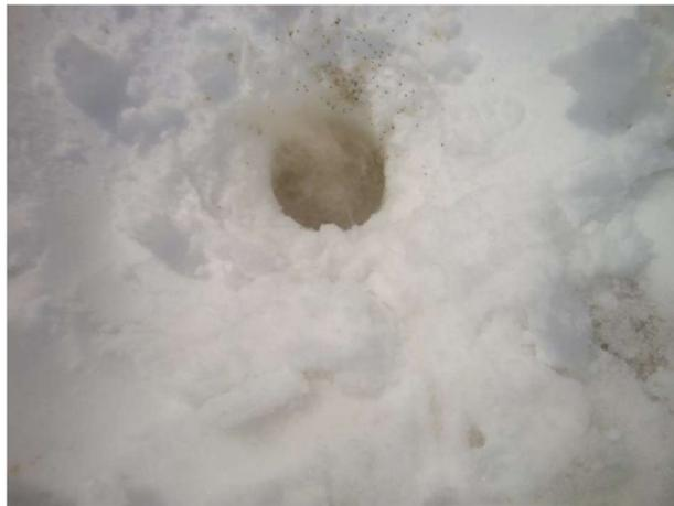
*Figura 5.12 Zona disturbata sulla superficie del manto nevoso in seguito all'esplosione della cartuccia (Gorret E., 2014)*
