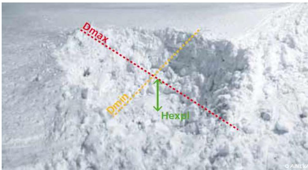
*Figura 5.1 Misure della geometria del cratere generato dall'esplosione*
