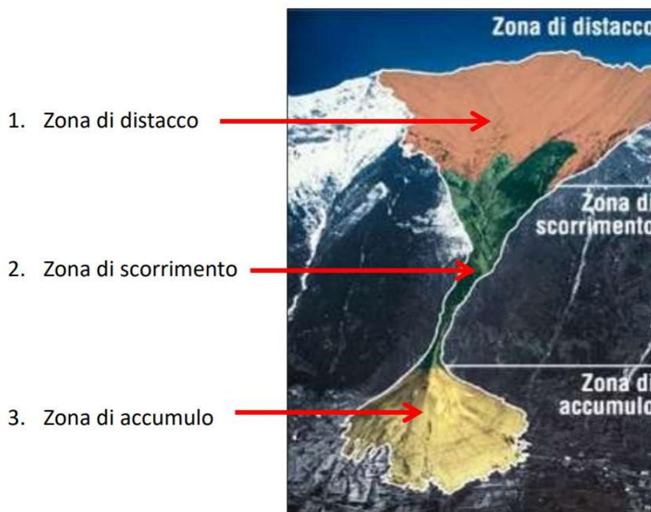
Figura 1.20 Schematizzazione dell'area valanghiva (Praolini et al., 2019)
