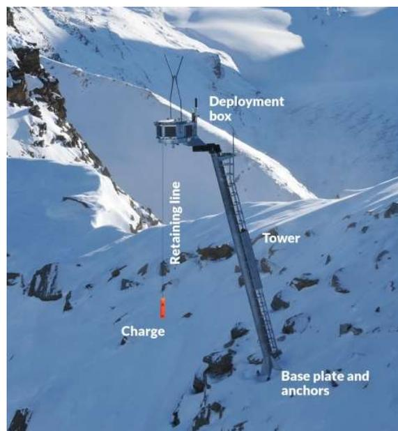
Figura 3.6 Parti funzionali del sistema Wyszen Tower (wysseavalanche.com)
