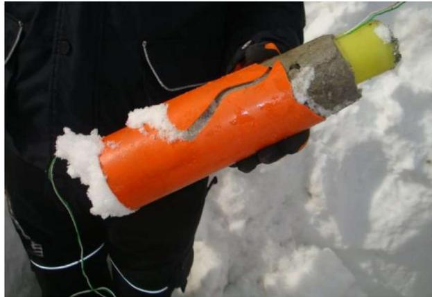
*Figura 5.11 Residuo rimasto dopo l'esplosione della cartuccia (Gorret E., 2014)*
