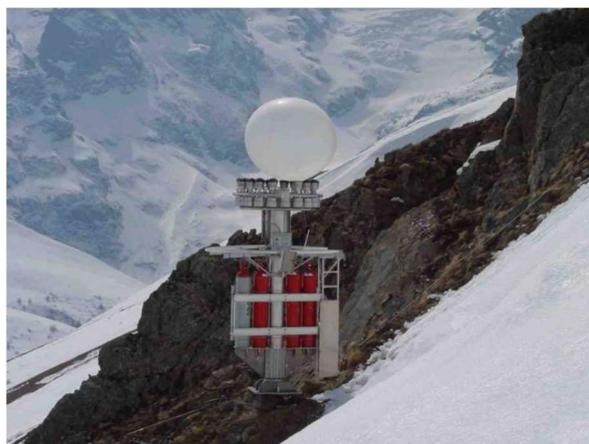
*Figura 3.11 Sistema Avalhex con un pallone pronto per la detonazione (Bruno E. et al., 2012)*
