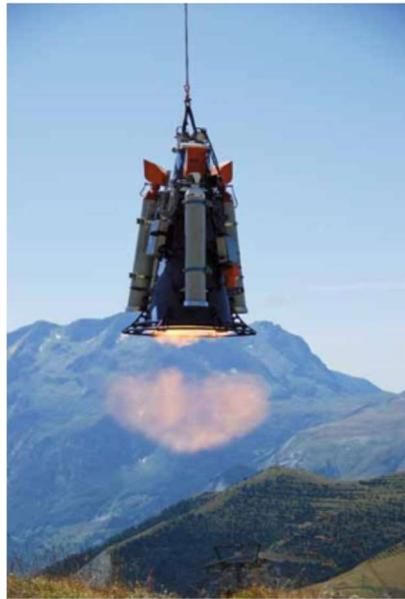
*Figura 3.14 L'esplosione della miscela gassosa nella campana del sistema Daisybell (Bruno E. et al., 2012)*
