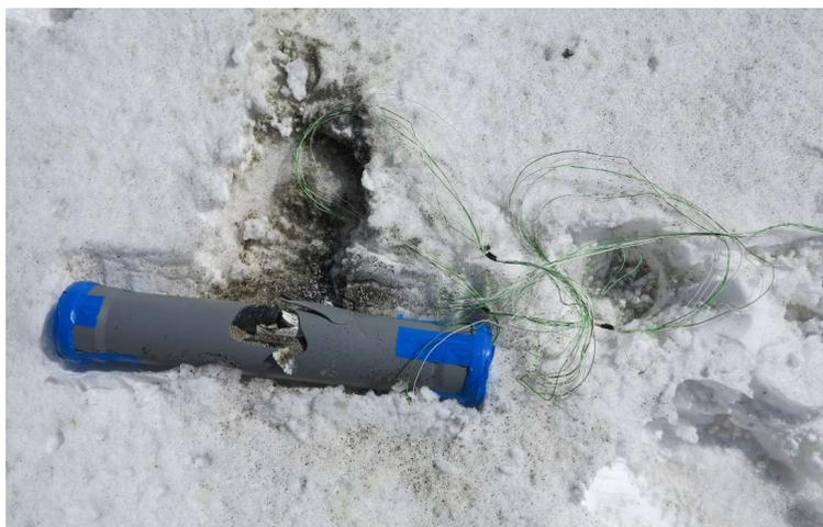
Figura 5.19 Tubo di plastica distrutto in seguito alla detonazione delle cariche di Autostem
