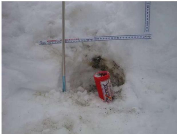
*Figura 5.10 Dimensioni del foro generato nel manto nevoso dall'esplosione della cartuccia (Gorret E., 2014)*
