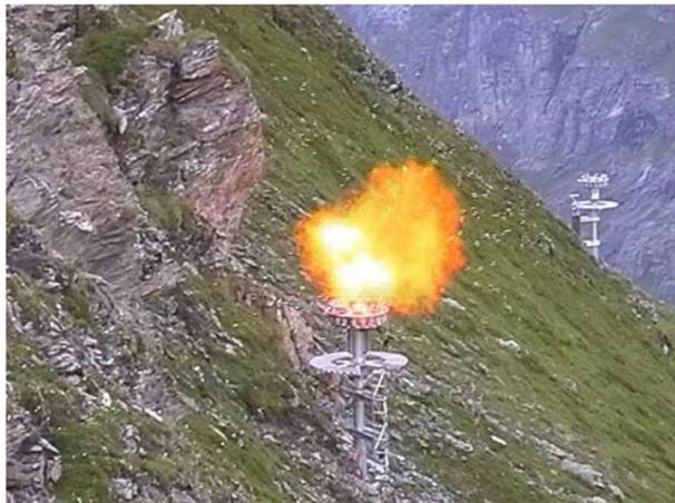
*Figura 3.12 Esplosione della miscela gassosa in un pallone del sistema Avalhex (Bruno E. et al., 2012)*
