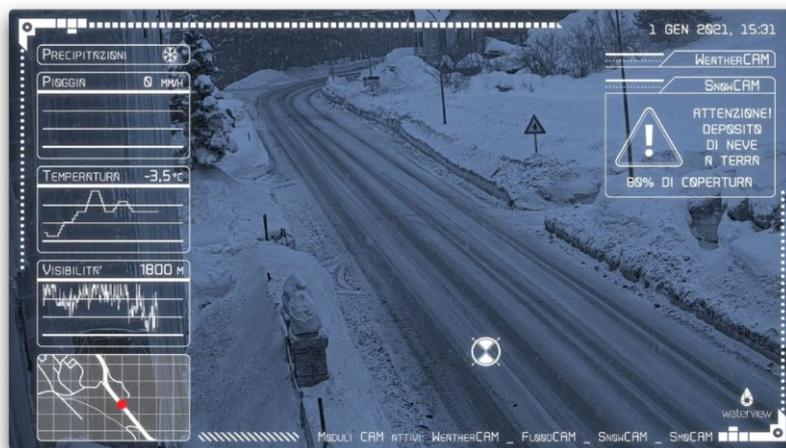
Figura 2.5 Pannello di controllo del monitoraggio meteo in tempo reale eseguito sulle smart camera della SS51 (Fonte: [WaterView - WE ARE HIRING: post | LinkedIn](#))
