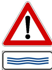
Figura 4.17 Segnale di attenzione e pannello integrativo per zone soggette ad allagamenti della sede stradale previsto dal Codice della Strada (Fonte: [Segnaletica stradale in Italia - Wikipedia](#))
