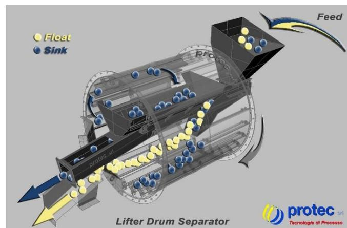
*Figura 40 - Separatore densimetrico.*
