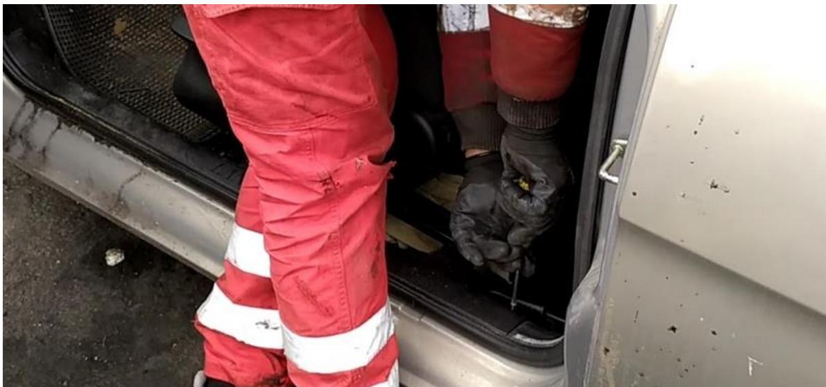
*Figura 20 - Rimozione del batticalcagno.*
