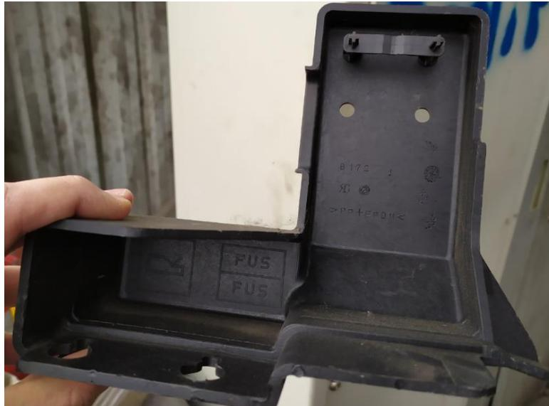
*Figura 12 - Vaschetta della batteria.*
