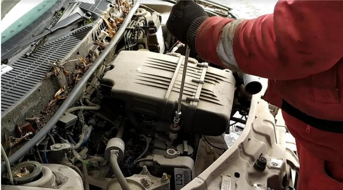
*Figura 19 - Rimozione del filtro dell'aria.*
