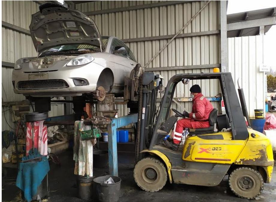
*Figura 15 - Posizionamento sul ponte.*
