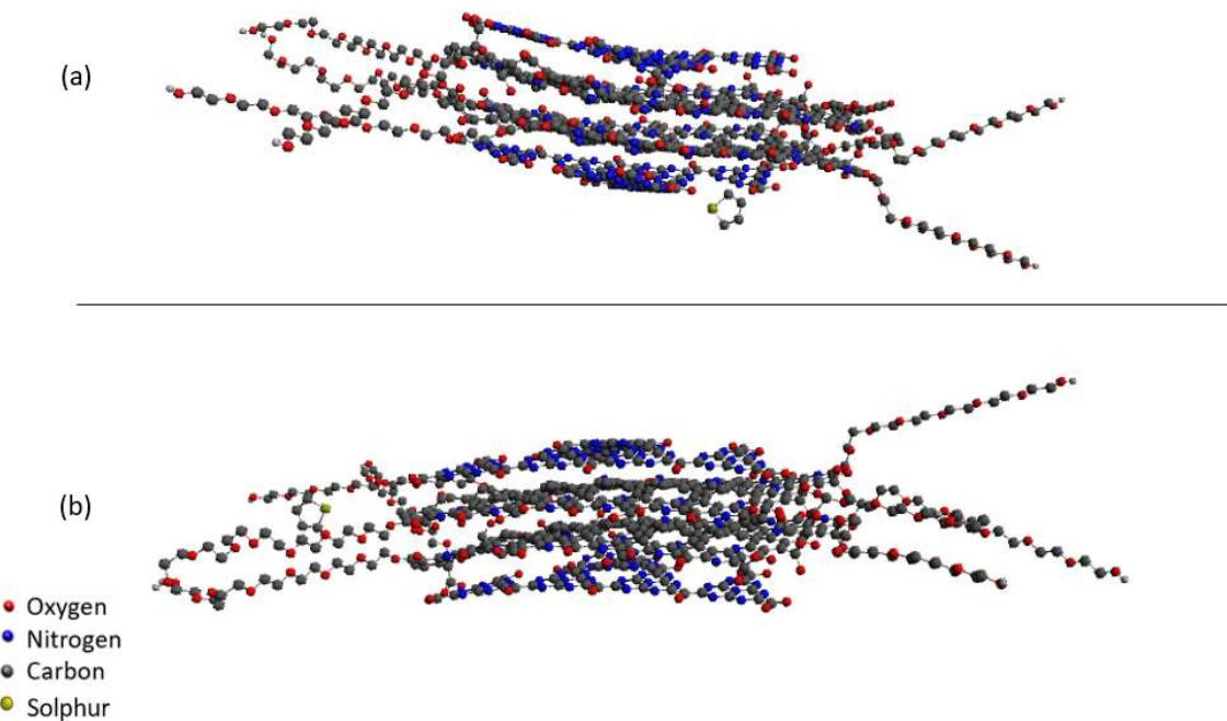
Figure VII Possibili configurazioni strutturali del Carbon Dot contenente PEG caricato con una molecola di tiofene.
