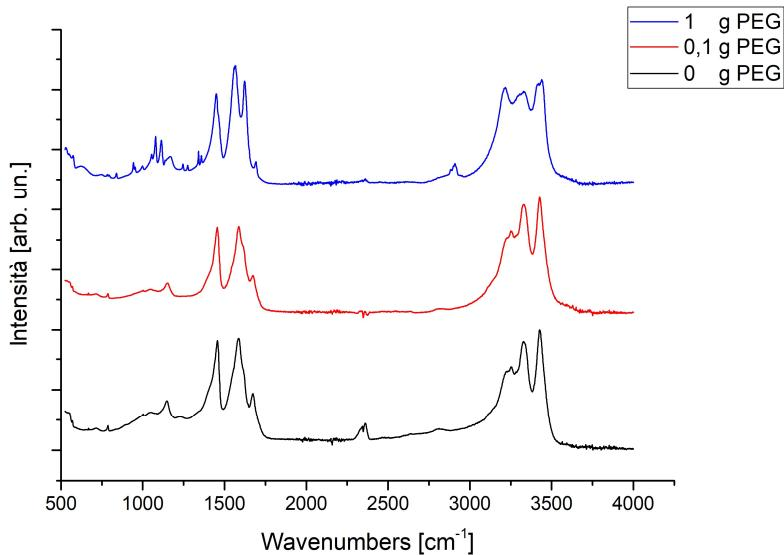
Figura II Spettri Precursori ottenuti mediante agitazione meccanica a diverse concentrazioni di PEG.
