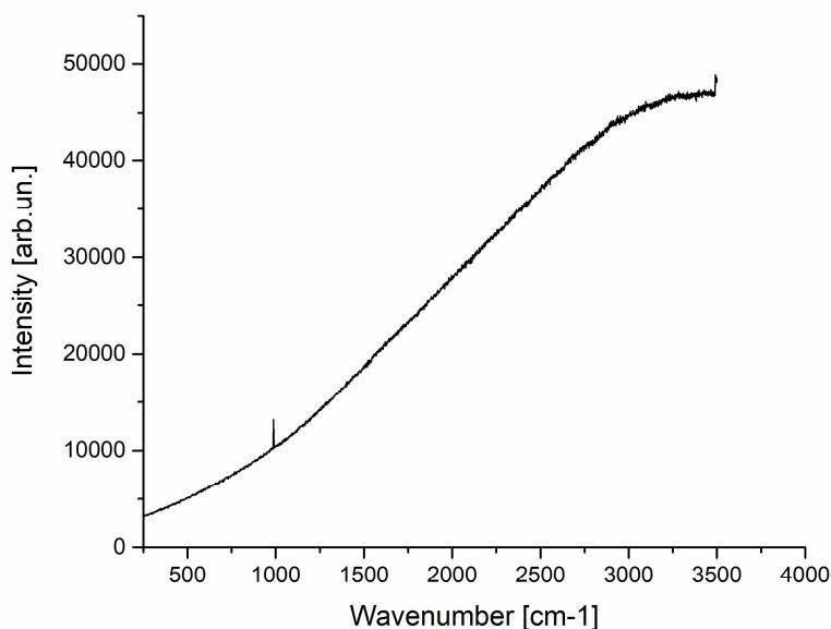
Figure IV Spettro Raman di Carbon Dots sintetizzati a 550 °C con un tempo di reazione di 10 minuti.
