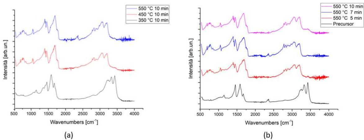
Figura III Spettri IR di (a) C-Dots prodotti dalle sintesi a diverse temperature da precursori privi di PEG, (b) C-Dots prodotti dalle
