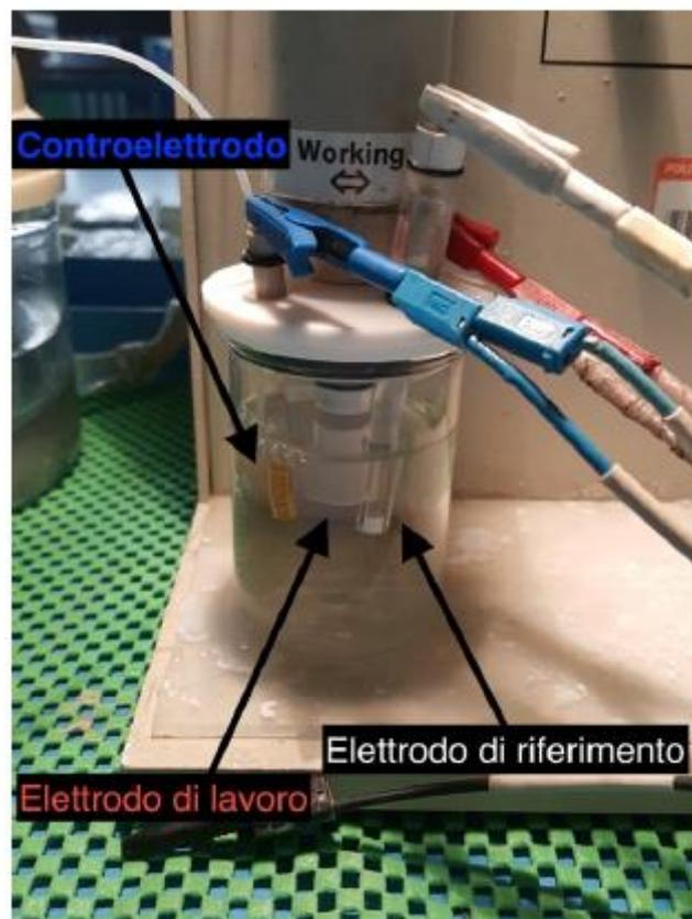
*Figura 19: sistema elettrochimico a tre elettrodi*
