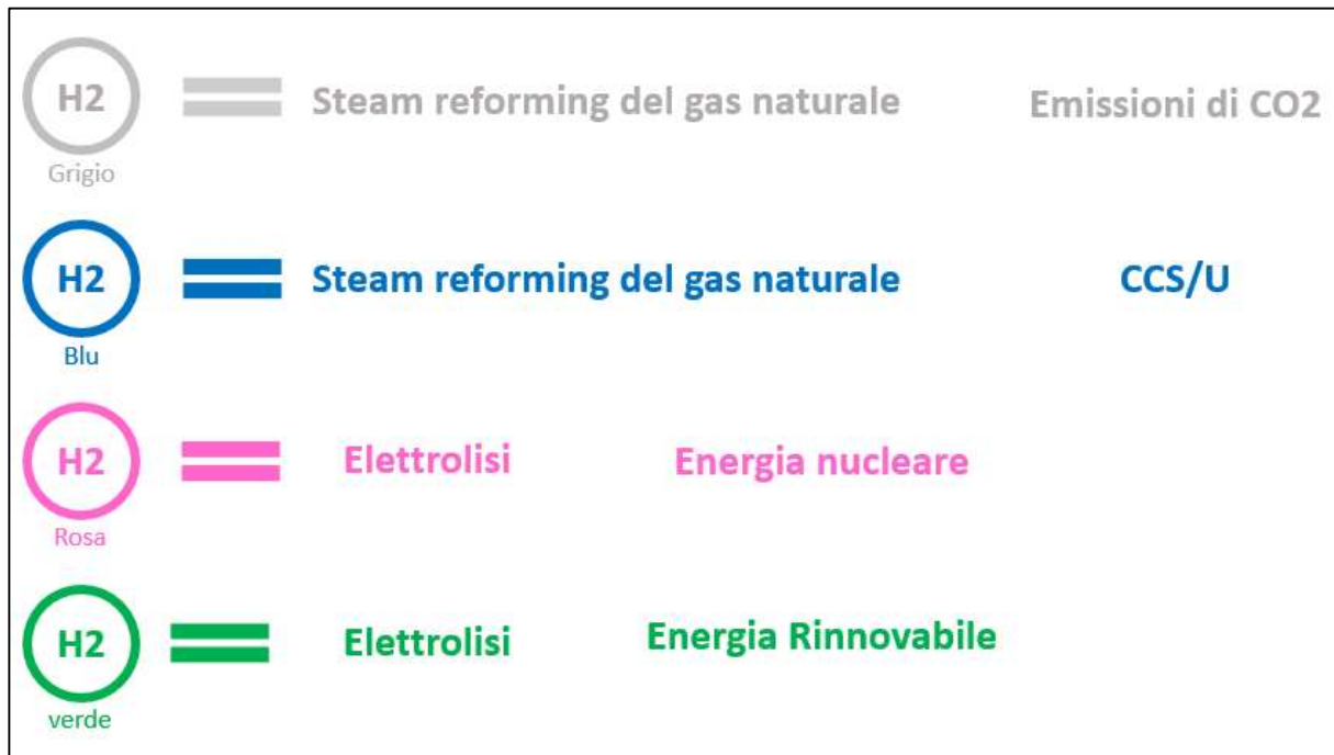
Figura 1.1 Schema dei colori dell'idrogeno, riferiti in base al metodo tramite il quale viene prodotto.
