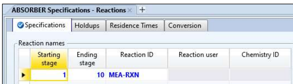
Figura 6.7 (cattura da Aspen). Inserimento delle reazioni nella colonna di assorbimento.
