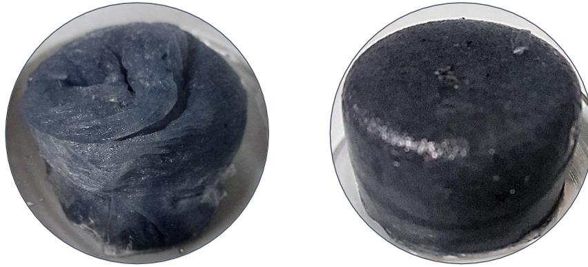
**Figura IV.12** - *agglomerati con microfibre disperse in a) alginato di sodio e b) carragenina*
