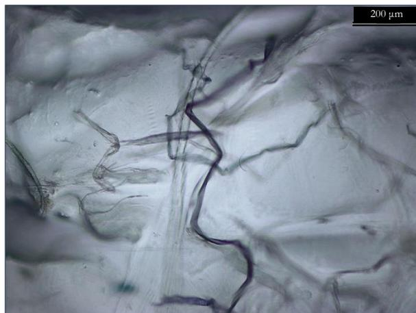
**Figura IV.15** - ingrandimento al microscopio ottico di microfibre inglobate nell'agglomerato di alginato di sodio
