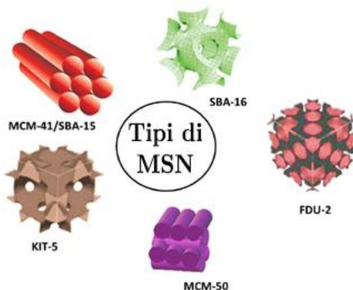
Figura 1.4.3. Tipologie di silici mesoporosi [20].
