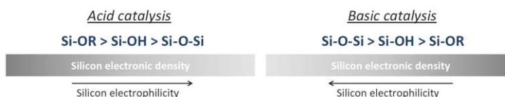
Figura 1.2.3. Specie del silicio nel processo sol-gel ordinate secondo la densità elettronica dell'atomo di silicio [13].
