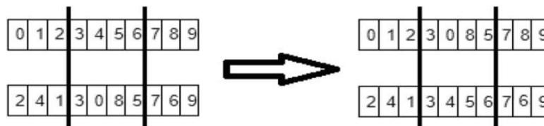
**Figura 0.2:** Esempio di crossover a 2 punti.
