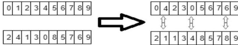
**Figura 0.3:** Esempio di crossover uniforme.
