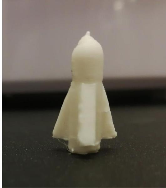
**Figura 3.45:** Razzo in PP COPO 12 + Talco prodotto con parametri dello step 2.
