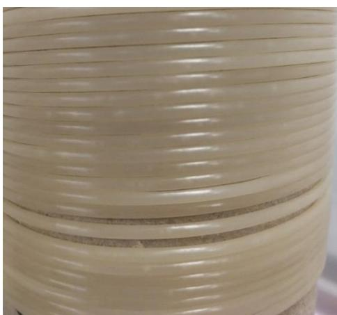
**Figura 3.27:** Filamento prodotto con il compound contenente cloisite-20A (FILO 2).
