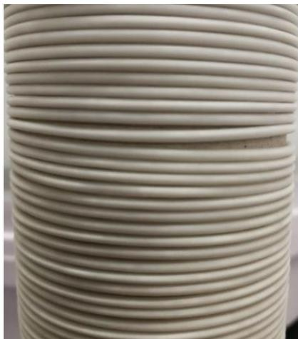
**Figura 3.21:** Filamento prodotto con il compound contenente talco (FILO 3).
