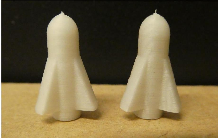
**Figura 3.46:** Razzi prodotti con PP+30%Talco con temperatura di estrusione pari a 200° C (a sinistra) e a 260° C (a destra).
