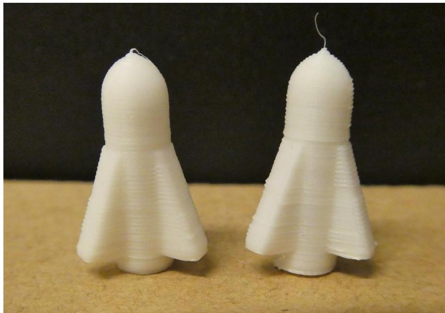
**Figura 3.47:** Razzi prodotti con PP+30%CaCO<sub>3</sub> con temperatura di estrusione pari a 200° C (a sinistra) e a 260° C (a destra).
