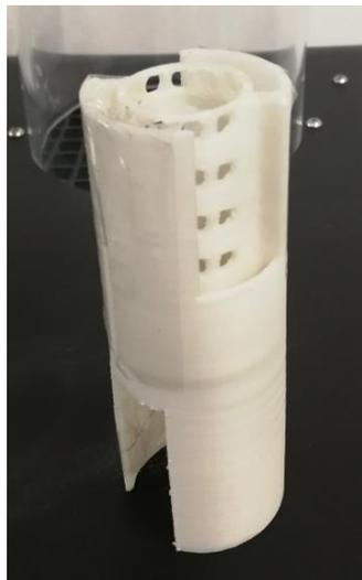
**Figura 2.14:** Componente utilizzato per rendere omogeneo il flusso d'aria direzionale delle ventole.
