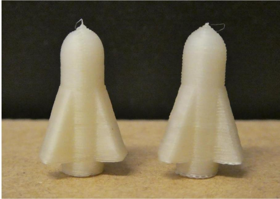
**Figura 3.48:** Razzi prodotti con PP+3%Cloisite-20A con temperatura di estrusione pari a 200° C (a sinistra) e a 260° C (a destra).
