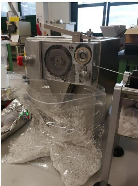
**Figura 3.9:** Dispositivo che taglia il filamento in pellet.
