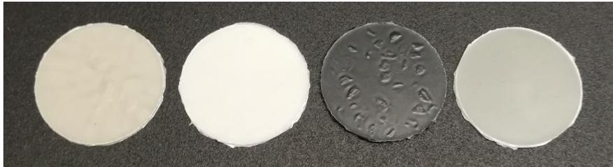
**Figura 3.1:** Campioni cilindrici per analisi al reometro, da sinistra: PP+30%Talco, PP+30%CaCO<sub>3</sub>, PP+30%SiO<sub>2</sub> e PP+3%PP-g-MA+3%Cloisite.
