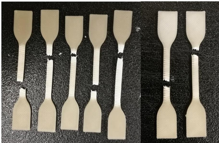
**Figura 3.60:** Provini dopo rottura, da sinistra Provino 1, Provino 2, Provino 3, Provino 4, Provino 5, Provino 6, Provino 7.
