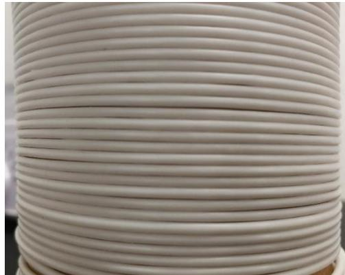
**Figura 3.24:** Filamento prodotto con il compound contenente carbonato di calcio (FILO 2).
