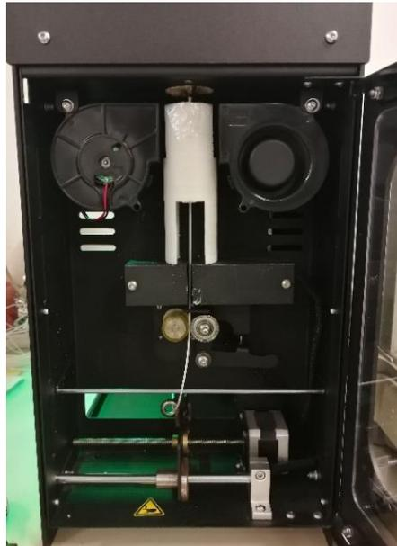
**Figura 3.20:** Sezione frontale dove fuoriesce il filamento dell'estrusore 3Devo.
