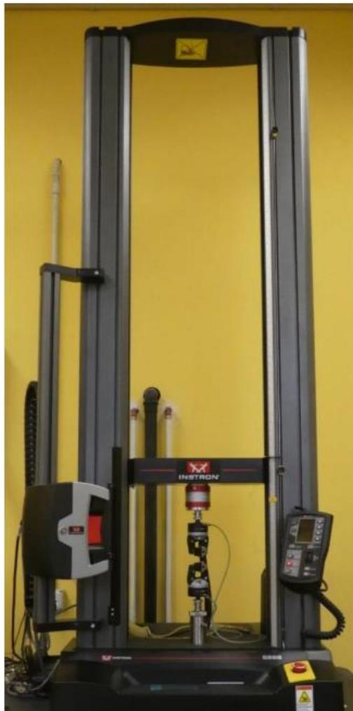
Figura 2.26: Dinamometro Instron 5966.
