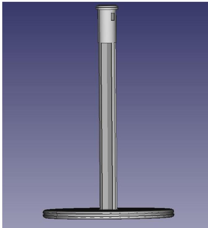
**Figura 5.14:** stantuffo 3.0. Il selettore diventa più largo in modo da non richiedere l'inserimento del componente a forma di imbuto
