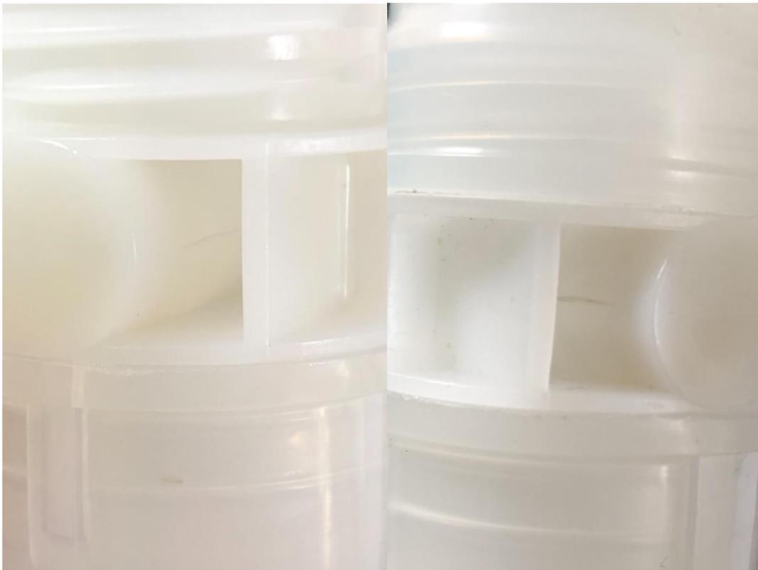
*Figura 4.2: Le regioni fratturate del raccordo del SecurBiop Double*
