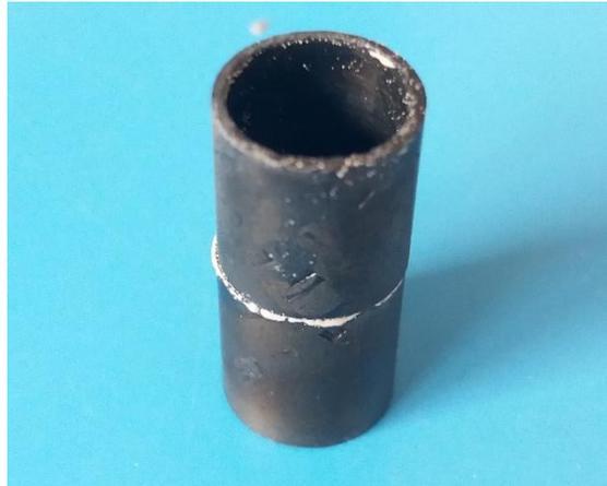
**Figura 3.7:** Due tubi di SiC forniti da CEA, giuntati con SAY.
