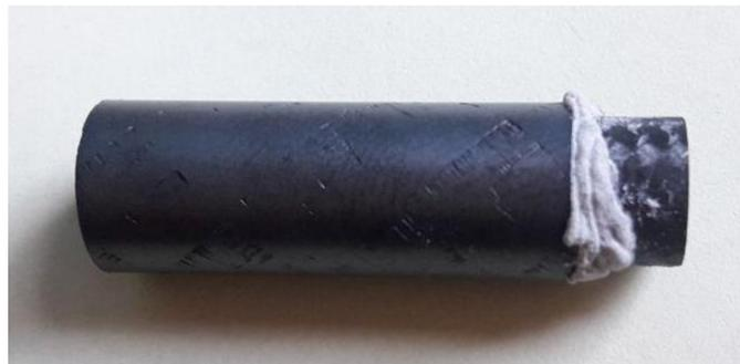
**Figura 3.8:** Tubo e tappo di tipo I di SiC, giuntati con SAY.
