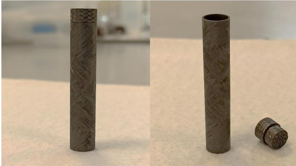
**Figura 3.10:** Campioni SiC/SiC di CEA configurazione tubo-tappo a) tubo chiuso con tappo b) i due elementi separati.
