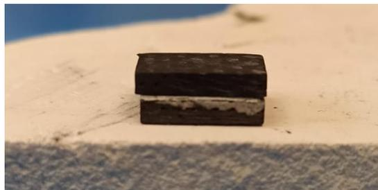
**Figura 5.15:** Campione di SiC<sub>f</sub>/SiC di tipo PIP giuntato efficacemente con vetroceramico SAY.
