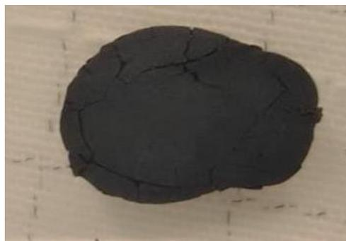
**Figura 4.11:** Aspetto del campione *bulk* di precursore Tethon-1 dopo trattamento termico TT8.
