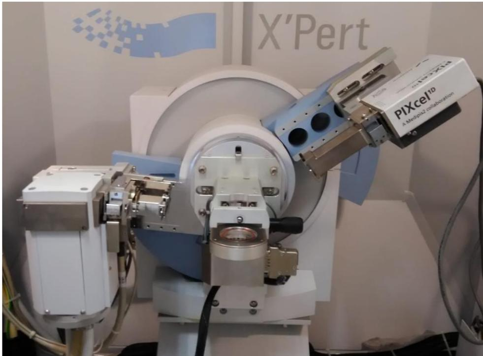
**Figura 3.23:** Strumento utilizzato per le analisi di diffrazione di raggi X.
