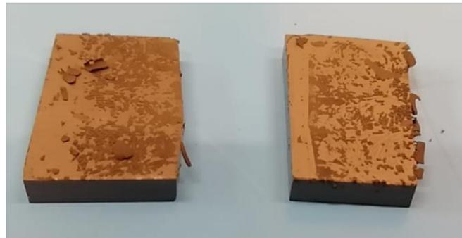
**Figura 4.12:** Aspetto delle superfici di giunzione con Tethon-1 dopo trattamento termico TT10.
