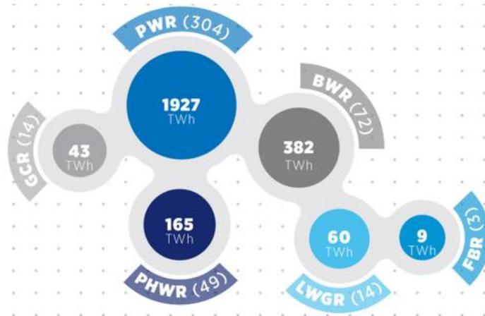
**Figura 1.2:** Energia annuale fornita da impianti nucleari, per tipo di reattore, con indicazione del numero di reattori per tipologia, riferito all'anno 2019 [4].
