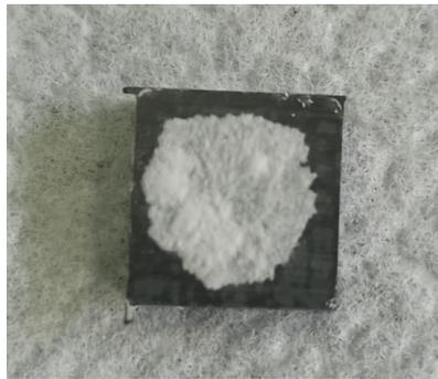
**Figura 3.43:** Strato di coating YAG trattato a 890°C per 30 minuti, su substrato di SiC/SiC (NITE).
