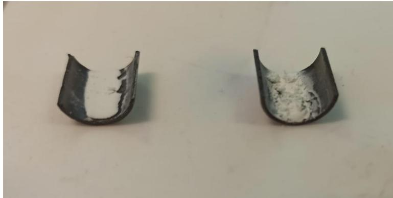
**Figura 3.46:** Campioni di composito SiCf/SiC con rivestimento di SiC CVD, con rivestimento di YAG mantenuto in forno a 890°C per un'ora (campione di sinistra) e due ore (campione di destra).
