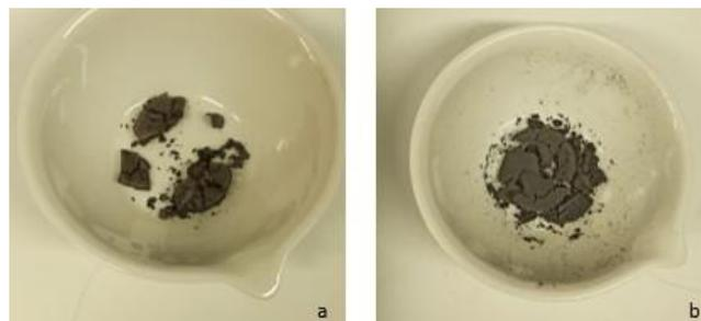
**Figura 2. 4** a)  $Mn_2O_3$  b)  $Mn_{85}(Fe,Cu)_{15}O_x$ , dopo calcinazione
