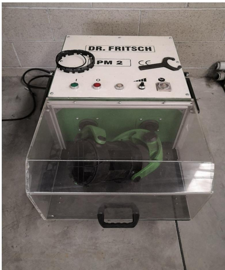
**Figura 3.2: Miscelatore meccanico di polveri metalliche con diverse velocità di mescolamento e capacità massima di 2 litri**
