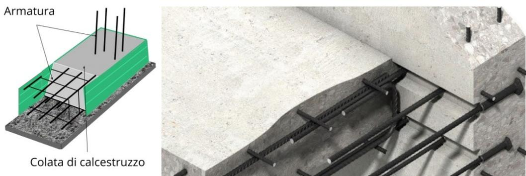
**Figura 1.1: Esempio di un materiale composito tra i più utilizzati in edilizia: il cemento armato**
