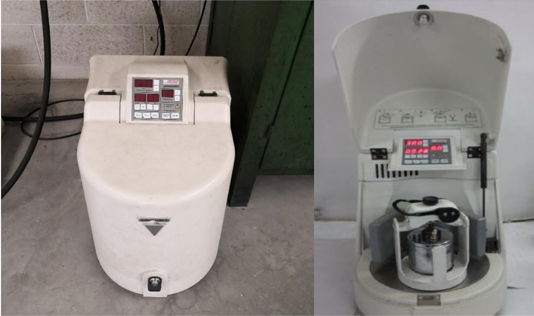
**Figura 3.3:** Immagine del mulino planetario a sfere ad alta energia al cui interno si osserva il cilindro dove vengono inserite le sfere e le polveri come nella Figura 3.4
