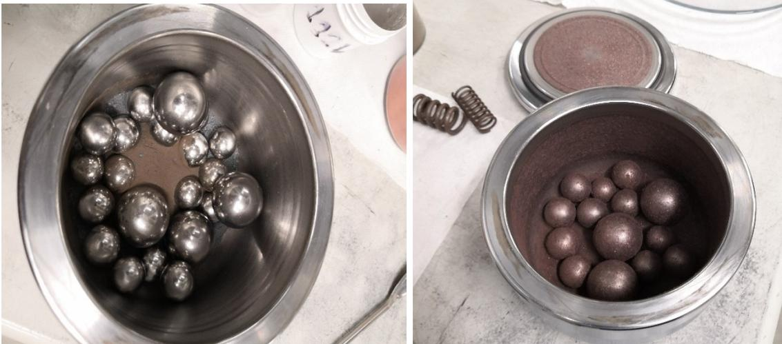
**Figura 3.4:** Immagine di sinistra relativa al caricamento delle polveri e delle sfere all'interno del cilindro dell'*High Energy Ball Milling*, l'immagine di destra è una foto dopo il processo di creazione dei fiocchi di composito.
