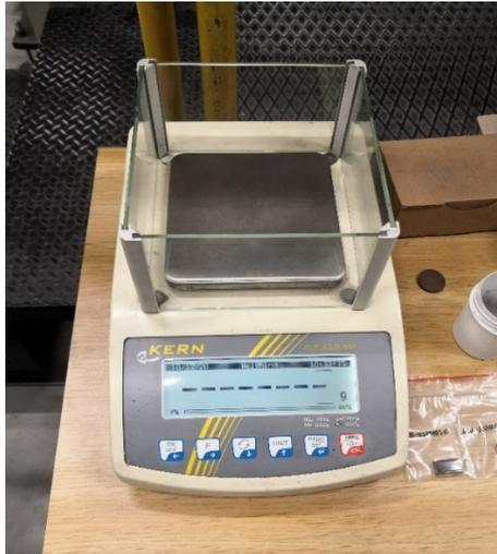
**Figura 3.1: Bilancia scientifica di precisione impiegata per pesare le polveri da utilizzare**
