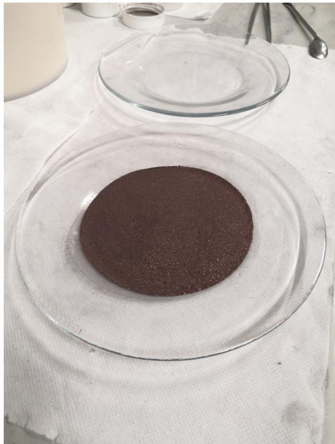
**Figura 3.5: Focchi di composito ottenuti dal processo di high energy ball milling**
