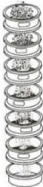
**Figura 2.7: Schematizzazione di un processo di setacciatura. Dall'alto verso il basso diminuisce la dimensione delle maglie delle siviere**
