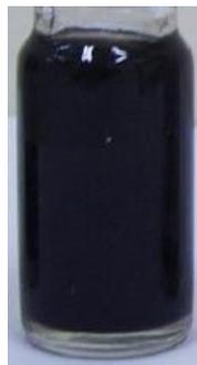
Figura 14 - Soluzione acquosa di MWCNTs funzionalizzati attraverso DEA <sup>[2,3]</sup>
