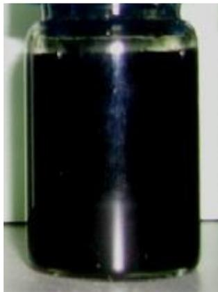
*Figura 18 - Soluzione di CNTs funzionalizzati attraverso soluzione piranha* <sup>[2.1]</sup>
