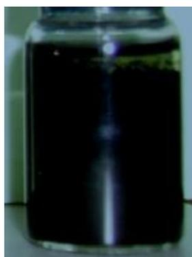
Figura 10 - Dispersione di CNTs funzionalizzati attraverso  $NH_4OH/H_2O_2$ <sup>[2.1]</sup>
