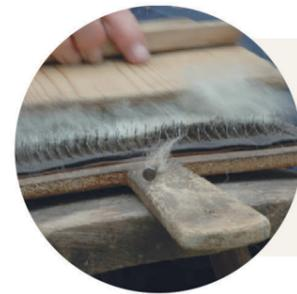
Avviene al termine del lavaggio e consiste nell'eliminazione delle impurità, dividendo e ponendo le fibre parallele, che renderanno le fasi successive più semplici. Avviene tra tre grandi cilindri muniti di spine metalliche perpendicolari al cilindro.
