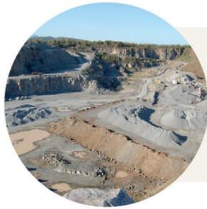
L'estrazione avviene generalmente nelle vicinanze del sito di costruzione. In questa fase è fondamentale selezionare ed analizzare il terreno. Selezionare una terra per Adobe significa scegliere un terra facile da modellare e lavorare e che contiene pochi sassi e ghiaia.
