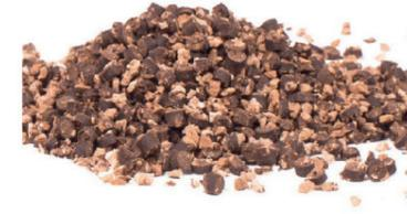
Il PVC sughero ha nella bassa densità la sua caratteristica peculiare e vanta una flessibilità d'impegno particolarmente interessante per tutti i settori della calzatura. Il PVC con sughero è un prodotto espanso additivato con granina di sughero. Il materiale può essere lavorato come un normale PVC espanso e per il suo utilizzo non richiede specifici accorgimenti nella fase di stampaggio. Il prodotto ha caratteristiche unificate in quanto a durezza e colore.
