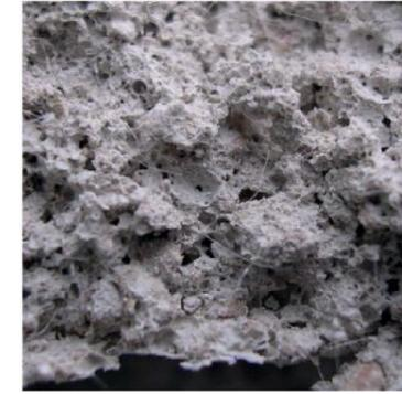
Intonaco premiscelato fibrinforzato con sughero, argilla, polveri diatomeiche e calce idraulica naturale. Composto naturale, pronto all'uso per la realizzazione di rivestimenti termici a cappotto e deumidificazioni per interni ed esterni. È un prodotto che sintetizza le caratteristiche di isolamento dal freddo del sughero con quelle di isolamento dal caldo della pietra. Le porosità e la calce presenti all'interno dell'intonaco lo rendono batteriostatico e antimuffa.
