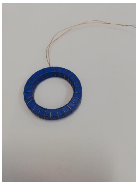
Figura 4.38 Dettaglio fotografico avvolgimento secondario.
