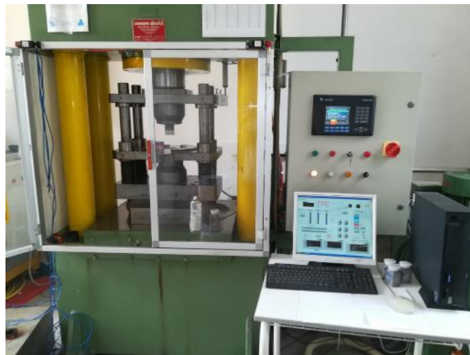
Figura 4.13 Pressa idraulica, e relativo pannello di comando, impiegata per la formatura dei green (Figura tratta da [6]).
