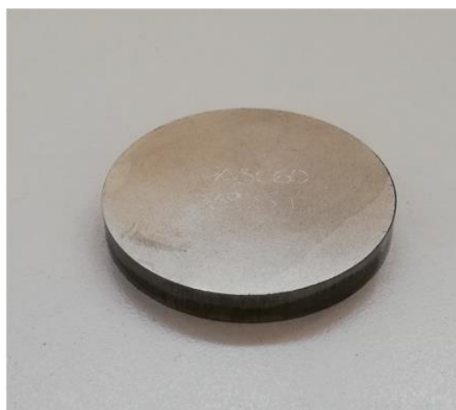
Figura 4.24 Geometria green campioni SMC con layer organico.
