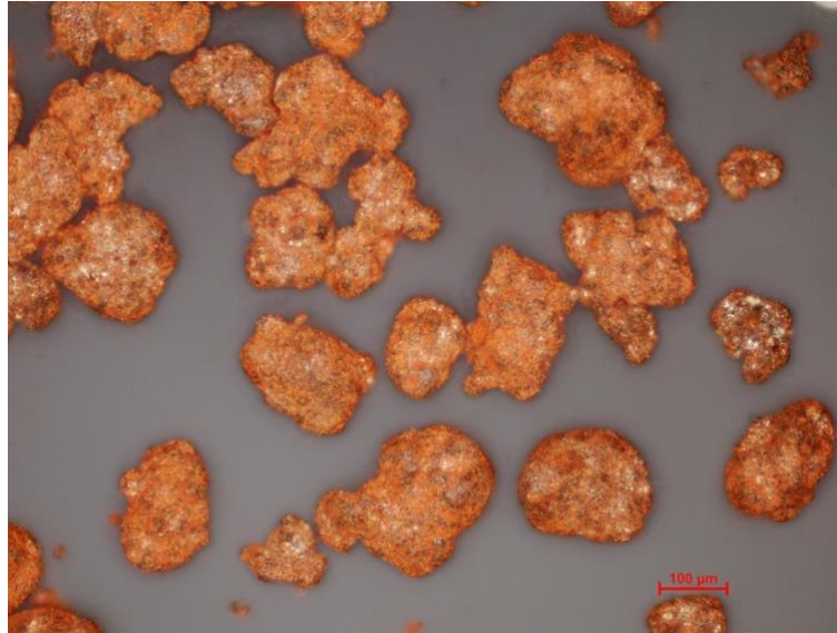
Figura 5.7 Micrografia ottica in luce polarizzata della miscela ferro ABC100.30 – Fe 2 O 3 allo 0,5%wt, per cui è stata prevista la settacciatura della frazione ferromagnetica finissima.
