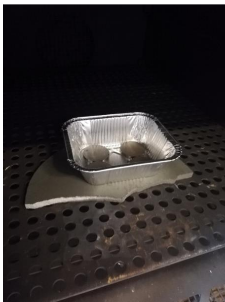
Figura 4.25 Dettaglio campioni in forno per trattamento termico di reticolazione.
