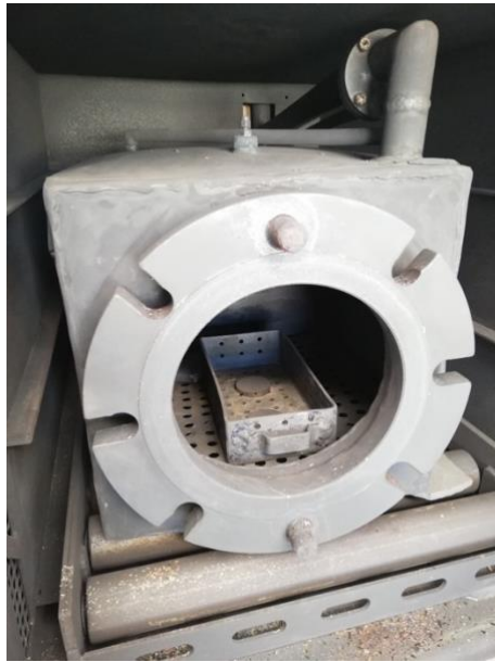
Figura 4.28 Sistema per il trattamento termico di debinding dei campioni di riferimento PASC60 Rif .
