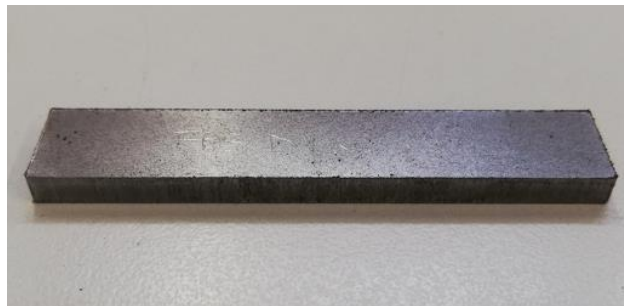
Figura 4.14 Geometria green campioni SMC con layer inorganico.
