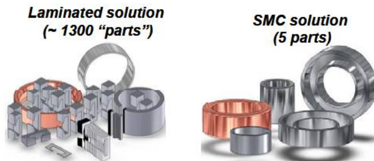
Figura 3.14 Numero di parti costituenti una macchina a flusso trasversale, nel caso di una soluzione con lamirini magnetici (a sinistra) o con gli SMC (a destra) (Figura tratta da [13]).
