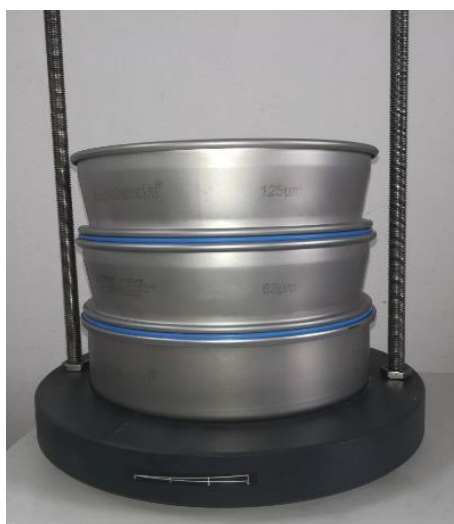
Figura 4.8 Setacci disposti in serie, con maglie di 125 \mu\text{m} e 63 \mu\text{m} (Figura tratta da [6]).
