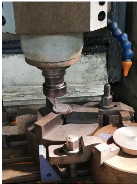
Figura 4.32 Dettaglio operazione di fresatura per realizzazione geometria toroidale.
