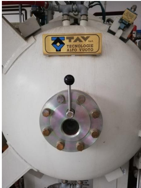
Figura 4.30 Forno per trattamenti termici in vuoto.
