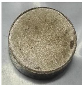
Figura 148: Campione di Al 6061/5% grafene, da polveri macinate, dopo trattamento termico T1. Si vede chiaramente la doratura superficiale.
