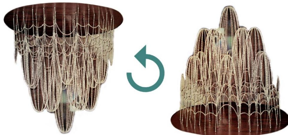
**Fig 9:** Modello a catene usato per la volta del piano interrato di Casa Milà a Barcellona.
