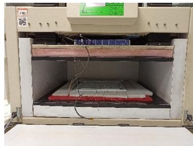
Fig. 39 Aggiunta di strisce di fibra di poliestere ai lati dei campioni
