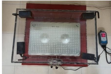
Fig. 25 Campione di PCM\_aluminium case\_c all'interno della teca di condizionamento
