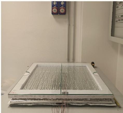
9. Intercapedine d'aria non ventilata sostenuta da una struttura in polistirene -lastra di vetro
