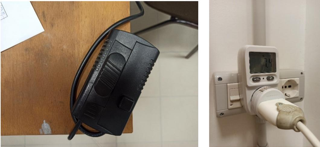
Fig. 49 Regolatore di tensione (a sinistra). Lettore potenza elettrica (a destra).
