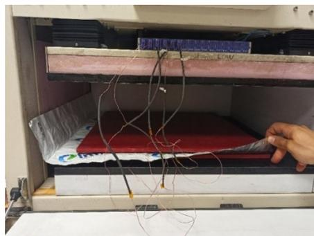
Fig. 36 Posizionamento del campione di PCM\_plastic film bags e dei tappetini di para rossa
