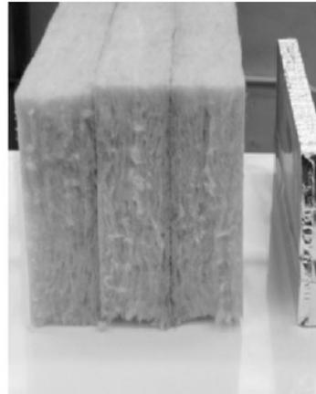
Fig. 10 Confronto (a sinistra) tra le conducibilità termiche di materiali isolanti convenzionali e avanzati e (a destra) tra lo spessore richiesto per l'isolamento convenzionale con della lana di vetro e un VIP.
