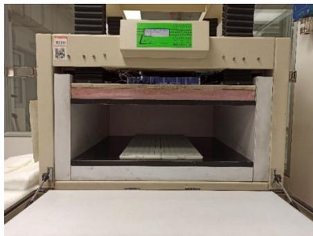
Fig. 32 Due campione di PCM\_plastic case\_c in piastra calda.
