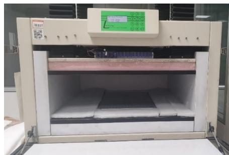
Fig. 26 Campione di PCM\_aluminium case\_c in piastra calda
