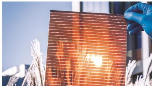
Fig. 13 Cristalli di Perovskite (a sinistra). Fonte:[15].Cella solare in Perovskite (a destra). Fonte: [20]
