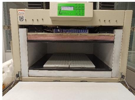
Fig. 35 Campioni di PCM\_plastic case\_b in piastra calda
