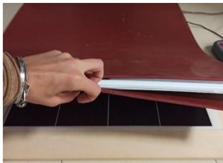
Fig. 27 Condizionamento pannello grazie all'utilizzo di un tappetino termo-riscaldante.
