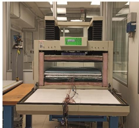
12. Inserimento del campione all'interno del termo-flussimetro
