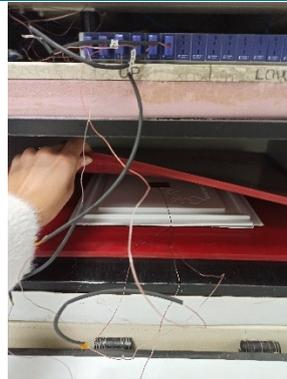
Fig. 38 Inserimento di due provini di PCM\_plastic container sovrapposti e di due tappetini di para rossa
