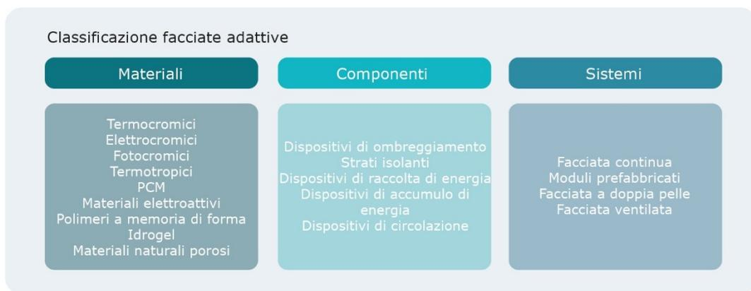
Fig. 3 Diagramma concettuale della classificazione delle facciate adattive (tradotto da [7]).
