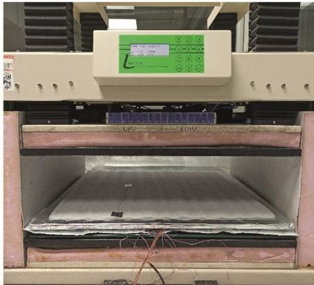
1. Rimozione del materiale multi-strato riflettente ed inserimento di un tappetino di PEX
