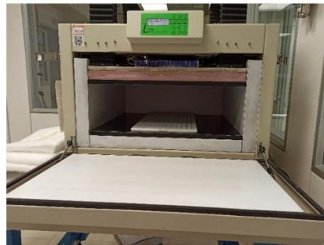
Fig. 31 Campione di PCM\_plastic case\_a all'interno del termo-flussimetro
