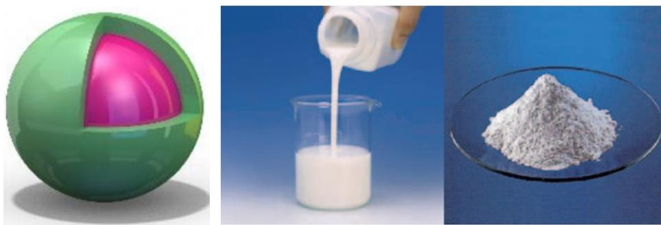
Fig. 5 PCM micro-incapsulato con nucleo in cera e guscio polimerico (a sinistra). PCM micro-incapsulato disperso in un liquido e in una polvere (a destra). Fonte: [10]
