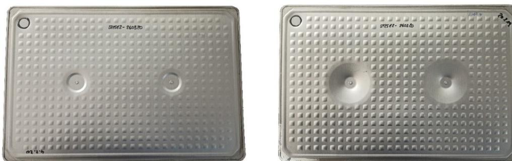
Fig. 19 Pannello CMS, spessore 10 mm (a sinistra). Pannello CSM, spessore 15 mm (a destra).
