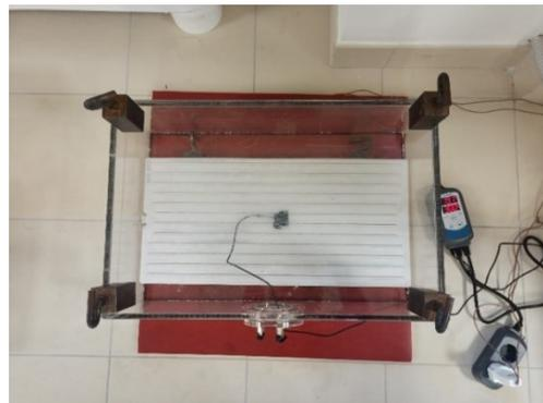
Fig. 18 Teca di condizionamento dei PCM.
