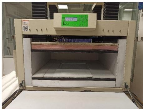
Fig. 30 Campione di PCM\_plastic container in piastra calda
