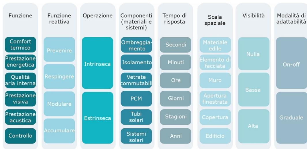
Fig. 2 Caratterizzazione elaborata da COST Action TU 1403 [7] in termini di tecnologie adottate e finalità (tradotto da [7]).
