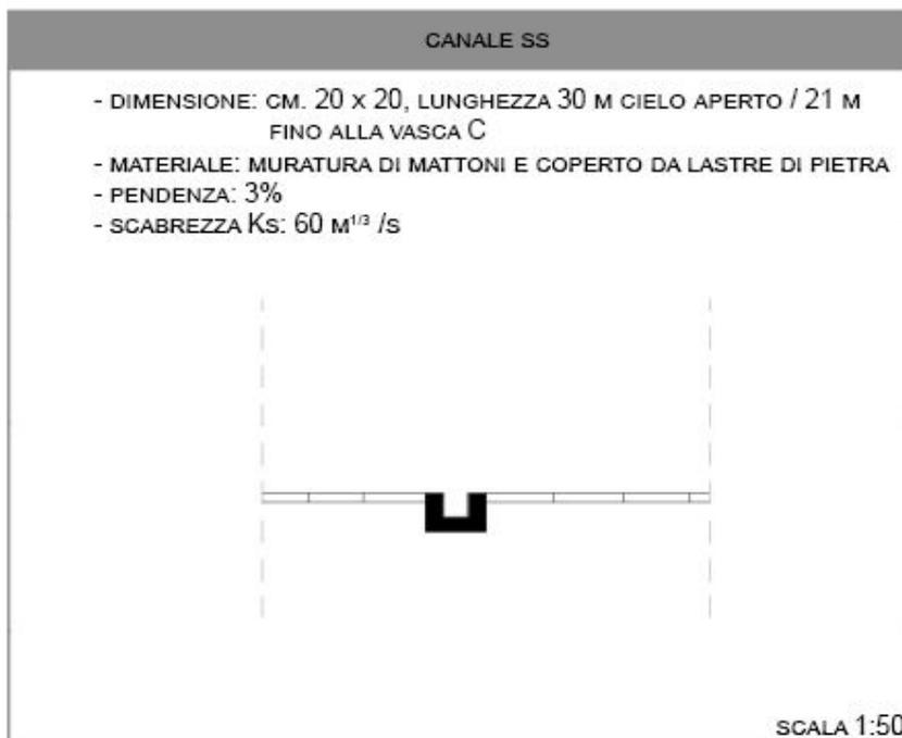
Poiché, generalmente, due dimensioni sono sufficienti a caratterizzare una sezione, in questo modo è possibile ricavare la dimensione rimanente, dall'equazione di moto uniforme. Scelta, dunque, la forma della sezione, si ipotizza il valore di una sua dimensione e si ricava, dall'equazione, il corrispondente valore della rimanente dimensione per la portata (Q), la pendenza (i) e la scabrezza assegnata (Ks).<sup>100</sup>
