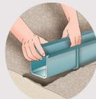
A. Posizionamento della canalina sul terreno secondo la pendenza naturale del pendio. Il profilo d'acciaio costituito da più blocchi viene collegato tramite saldatura.
