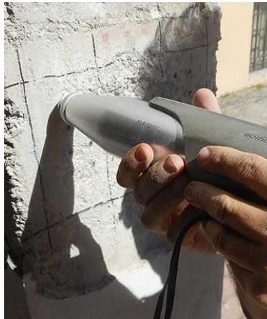
Figura -25 Fotografia che mostra l'utilizzo dello sclerometro su pilastro in calcestruzzo armato (progettosp.com)
