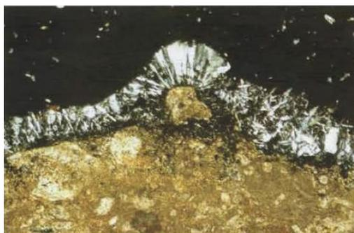
Figura -11 Micrografie in sezione sottile di aree nere osservate a nicols incrociati, eseguite trasversalmente alla superficie del materiale lapideo, si mostra la presenza di frammenti di materiale originale inglobati nella crosta di gesso a dimostrazione del fatto che il gesso costituente questo strato superficiale deriva da un processo di solfatazione del carbonato di calcio (Dario Camuffo, 1985)
