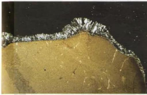
Figura -8 Micrografie in sezione sottile di aree nere osservate a nicols incrociati, eseguite trasversalmente alla superficie del materiale lapideo. Evidente presenza di strato superficiale di cristalli di gesso aghiformi perpendicolari alla superficie (Dario Camuffo, 1985)
