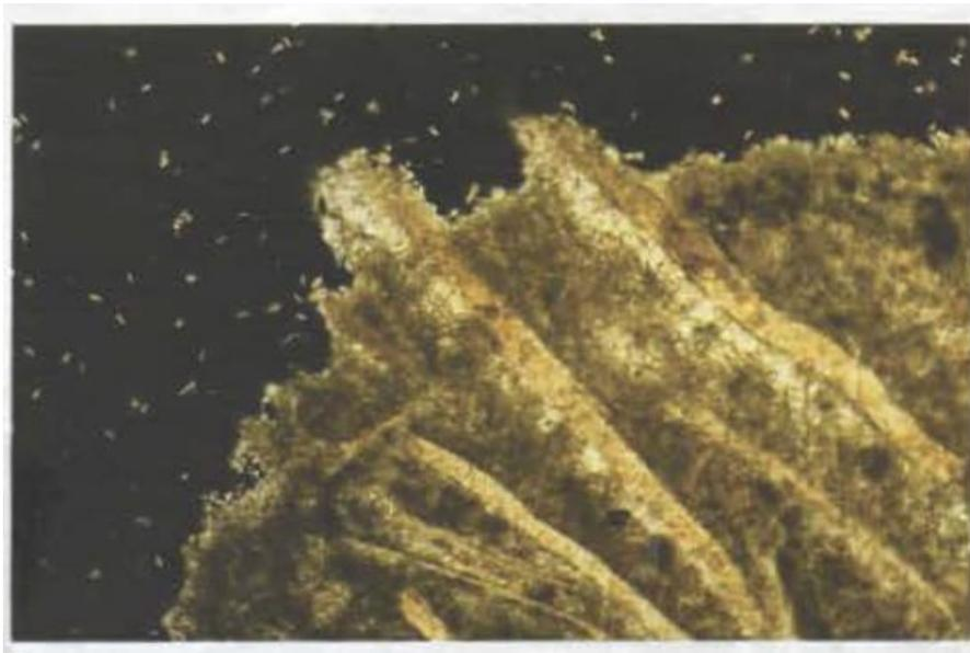
Figura-12 micrografia in sezione sottile di un frammento appartenente all'area bianca. La pietra ha subito forte dissoluzione superficiale ma i bioclasti di calcite, più resistenti all'attacco chimico, appaiono in rilievo. Assenza di cristalli di calcite secondaria (D.Camuffo, 1985)
