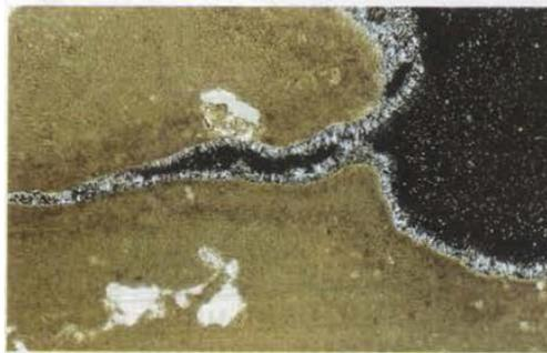
Figura-9 Micrografie in sezione sottile di aree nere osservate a nicols incrociati, eseguite trasversalmente alla superficie del materiale lapideo, mostra il formarsi di cristalli di gesso anche all'interno di fratture e crepe del materiale (Dario Camuffo, 1985)
