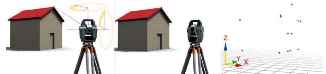
▲ **Orientamento degli angoli e della direzione per la collimazione del punto da misurare nel sistema di riferimento.**
