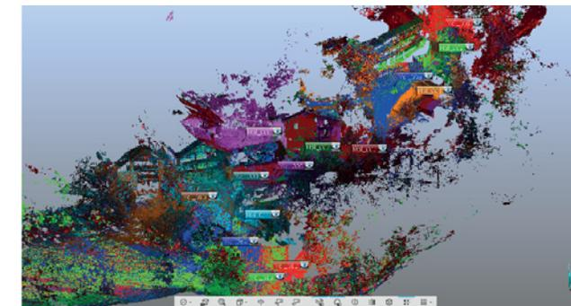
◀Visualizzazione delle nuvole LiDAR registrate e unite nel software Scene. Ogni nuvola è indicata con un falso colore differente, per facilitare l'operazione di avvicinamento utile all'unione per forma.
