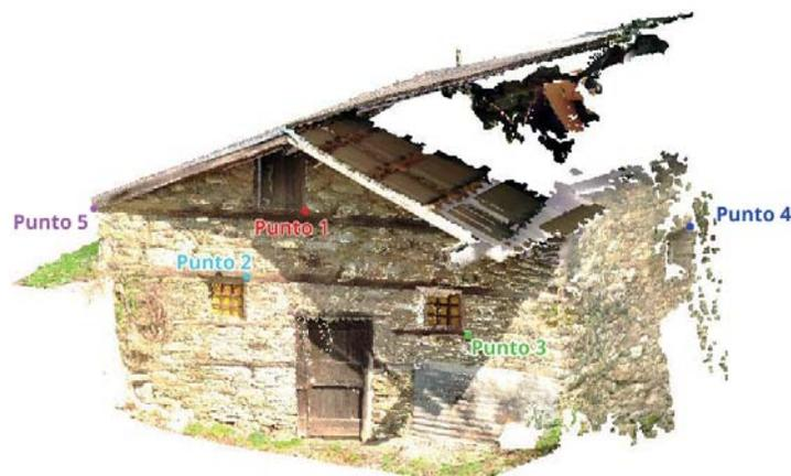
I punti ricavati sono stati inseriti tramite file di testo csv nel programma Metashape, collimandoli in tutte le foto; 4 sul prospetto nord e 1 sul prospetto est. Si è proseguito con l'aggiustamento della camera e con la generazione della nuvola di punti densa.
