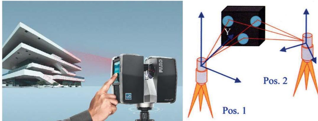
▲ **Utilizzo di uno scanner TSL FARO per il rilievo delle architetture.**
