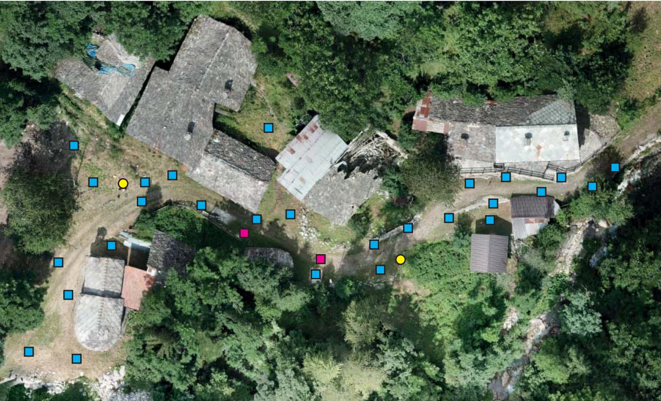
▲ Distribuzione dei punti di dettaglio a terra. In azzurro i punti materializzati tramite target; in rosa i punti di dettaglio naturali; in giallo i vertici della rete di inquadramento. Come si può notare la distribuzione è omogenea in tutto l'insediamento. Ortofoto fotogrammetrica aerea georeferenziata in WGS84/UTM32N.
