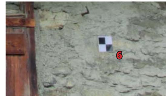
◀ Foto del tipo di target usato per questa fase di rilievo, diverso da quello usato per i punti a terra.
