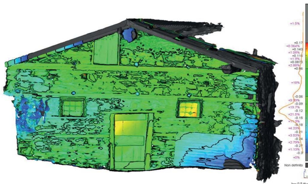
▼ Prospetto Ovest realizzato dal software Poin Cab, passo per la vettorializzazione dei prospetti dopo l'elaborazioni dei dati ottenuti dalla campagna di rilievi
