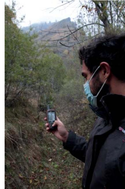
◀ **Fotografia durante il rilievo del tracciato dell'antica strada che collegava le Borgate di Chiosso e Molini rilievo con il GPS/GNSS della Garmin**
