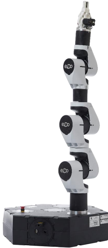
Figura 26 e.DO robot in posizione di calibrazione. Da questa vista è possibile individuare il basamento, l'end-effector (la pinza) e il corpo del braccio, costituito da una serie di elementi modulari
