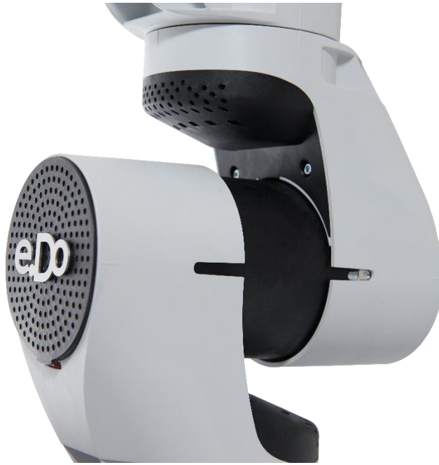
Figura 27 Dettaglio del braccio robotico: pe componenti bianche (strutturali) prendono il nome di "esostaffe", mentre le parti nere cilindriche (motori) sono dette "giunti"
