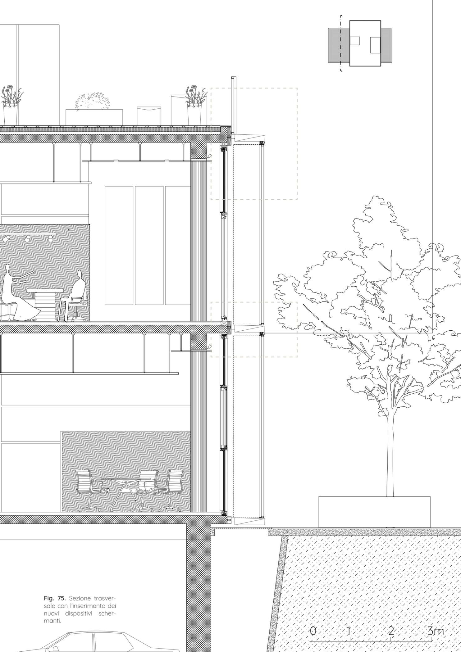
Fig. 75. Sezione trasversale con l'inserimento dei nuovi dispositivi schermanti.
