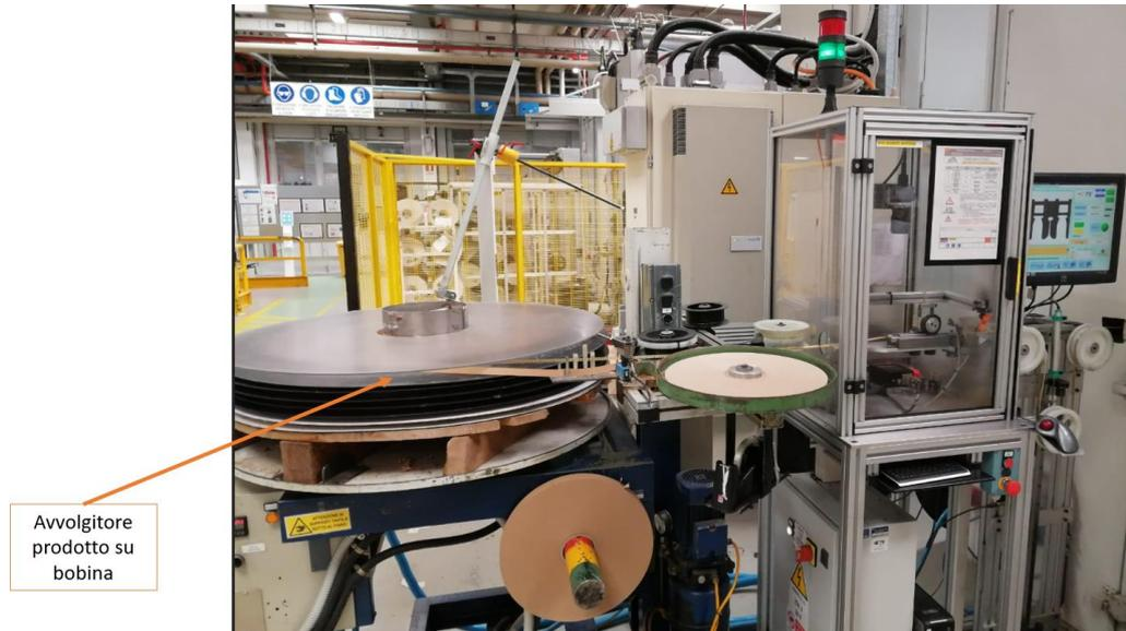
*Figura 2.1. 4 – Avvolgitore bobina per prodotto finito*
