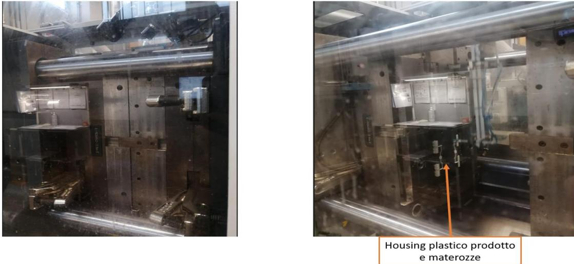
*Figura 2.1. 7 Stampo chiuso durante l'iniezione del materiale fuso (Sinistra); Stampo aperto con prodotto stampato (destra)*
