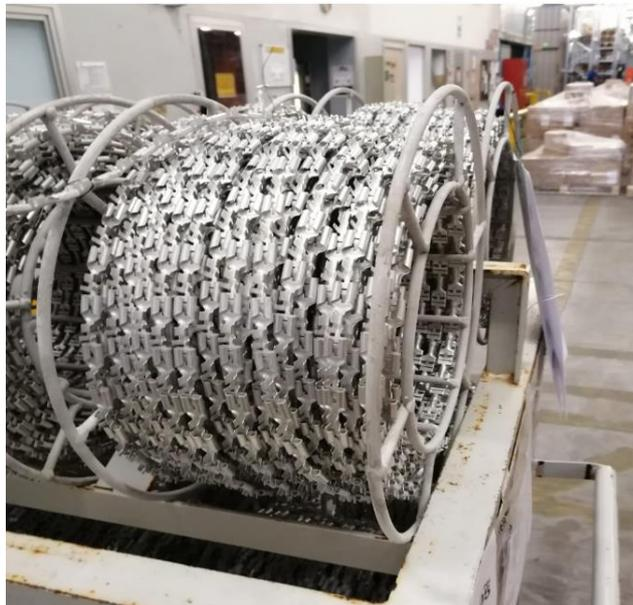
*Figura 2.1. 5 – bobina di connettori metallici*
