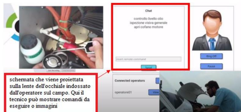
Figura 1.2. 10 – esempio di applicazione di supporto della realtà aumentata per manutenzione motore - [www.headapp.it](http://www.headapp.it)
