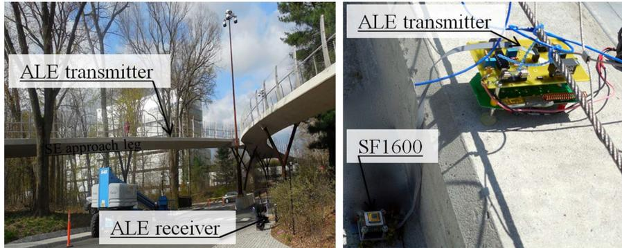
Figura 4.8: Test setup e impiego dell’ALE sul ponte [2]
