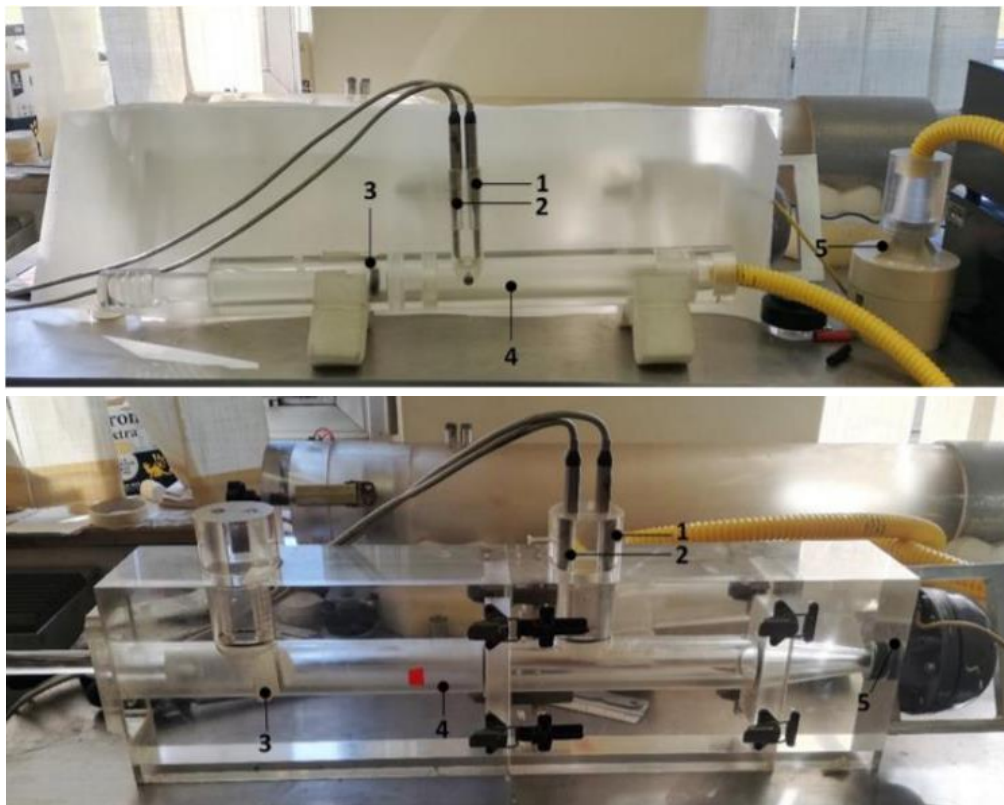
Figura 26 Tubi di Kundt utilizzati presso i laboratori INRiM: In alto il tubo da 30mm, in basso il tubo da 50mm
