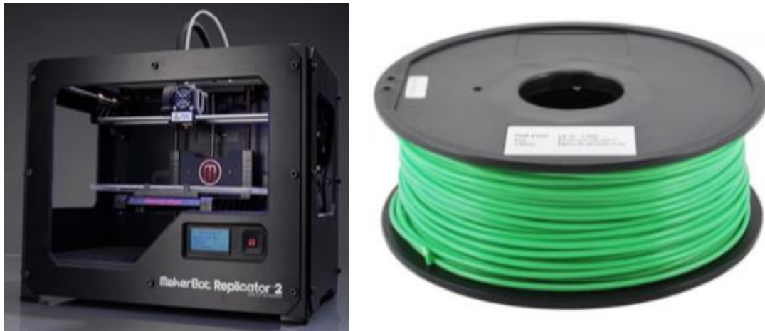
Figura 24 Stampante per la modellazione a deposizione fusa Maker Replicator 2 e relativa bobina di materiale termoplastico
