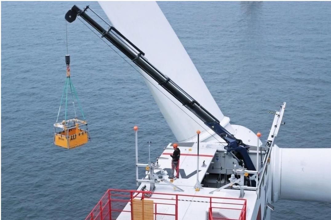
Figura 1.3: Gru foldable installata nel vano macchine della gondola di una turbina eolica
