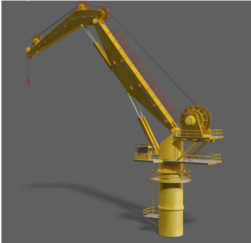
Figura 2.2: modello CATIA 3D di una gru foldagle non telescopica
