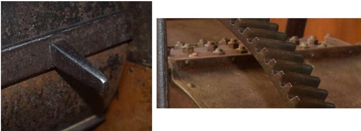
Figura 7: Zoom dente battitore e sistema di bloccaggio sul controbattitore (serie di dadi in vista)
