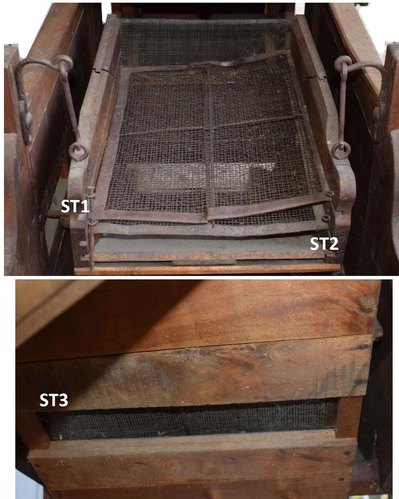
Figura 61: Blocco setacci con ST1 e ST2 (in alto); setaccio ST3 sullo scivolo di raccolta (in basso)
