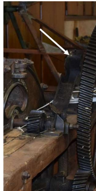
Figura 15: Sistema di lubrificazione (sx) e sicurezza (dx)
