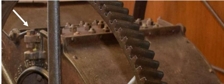
Figura 8: Vite di regolazione altezza dentatura controbattitore (CB)
