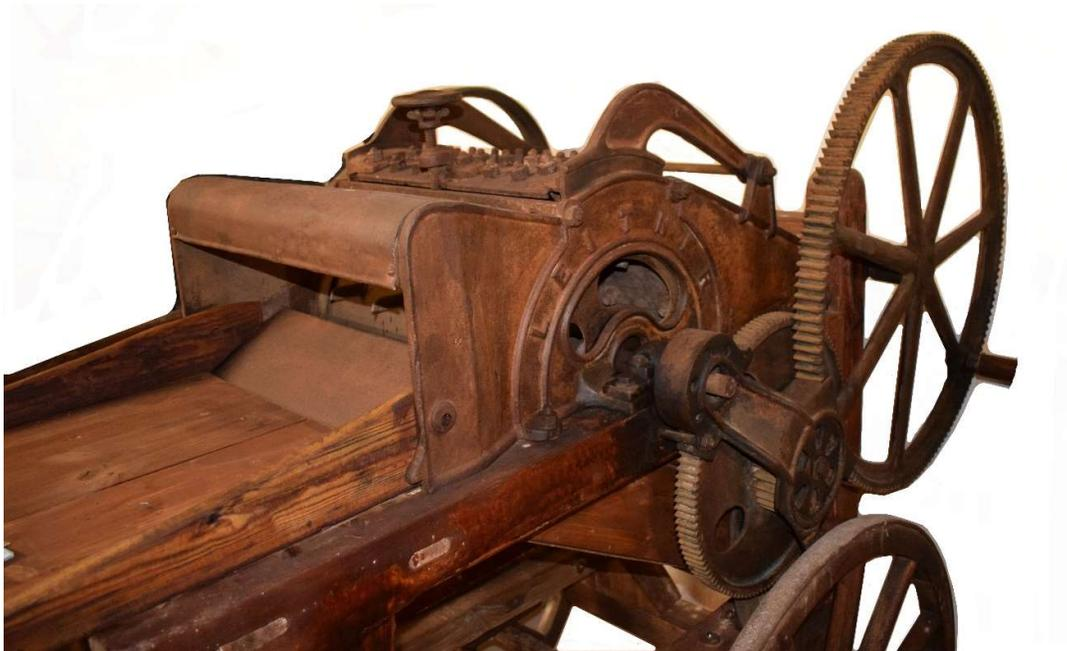
Figura 16: Trebbiatrice Leitner (A) con trasmissione ad ingranaggi
