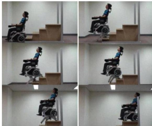
Figura 1.9 – Carrozzina a zampe Bang.
