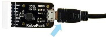
Figura 4.8 – Adattatore USB e cavo Micro-USB.
