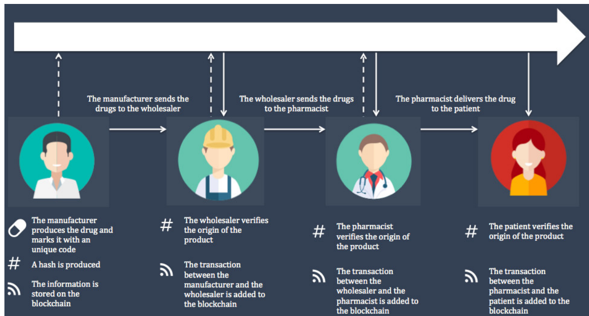
Figura 20: Blockchain per il tracciamento dei farmaci. Al momento della loro produzione, viene generato un hash contenente tutte le informazioni sui farmaci. Le informazioni vengono registrate sulla blockchain ad ogni passaggio del farmaco, facilitandone il tracciamento [35].
