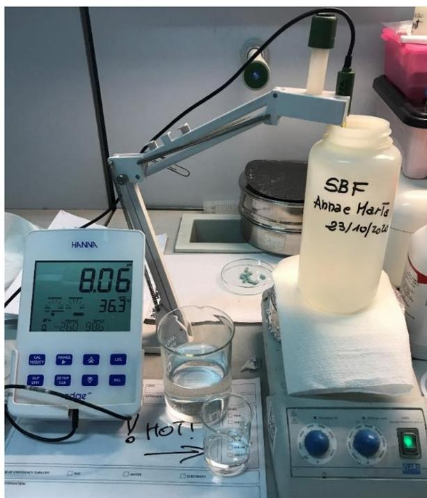
**Figura 7.3:** Becher di plastica, su piastra riscaldante, all'interno del quale viene preparata l'SBF; pHmetro inserito all'interno del becher per misurare il pH della soluzione; display che mostra il valore del pH ed il valore della temperatura.
