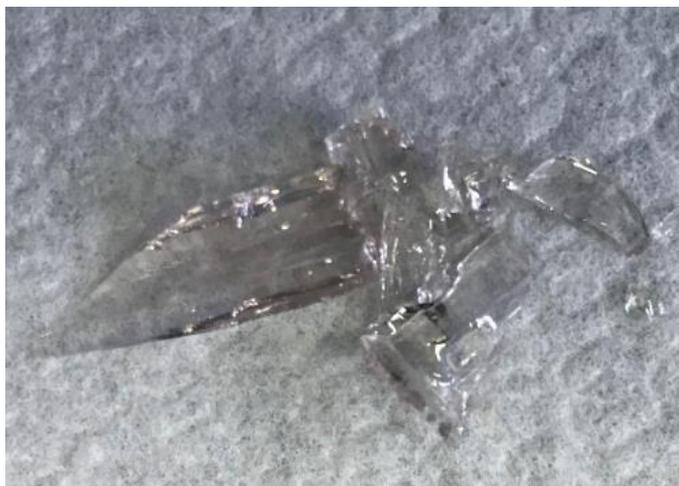
**Figura 7.7:** *Vetro 45S5 fuso a 1450 °C e colato in stampo di ottone preriscaldato a 580 °C, dopo il completo raffreddamento ed apertura dello stampo.*
