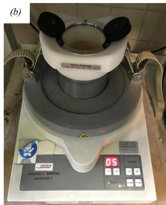
**Figura 7.1:** (a) mortaio e corpo macinante in zirconia; (b) macinazione in macinatore automatico.
