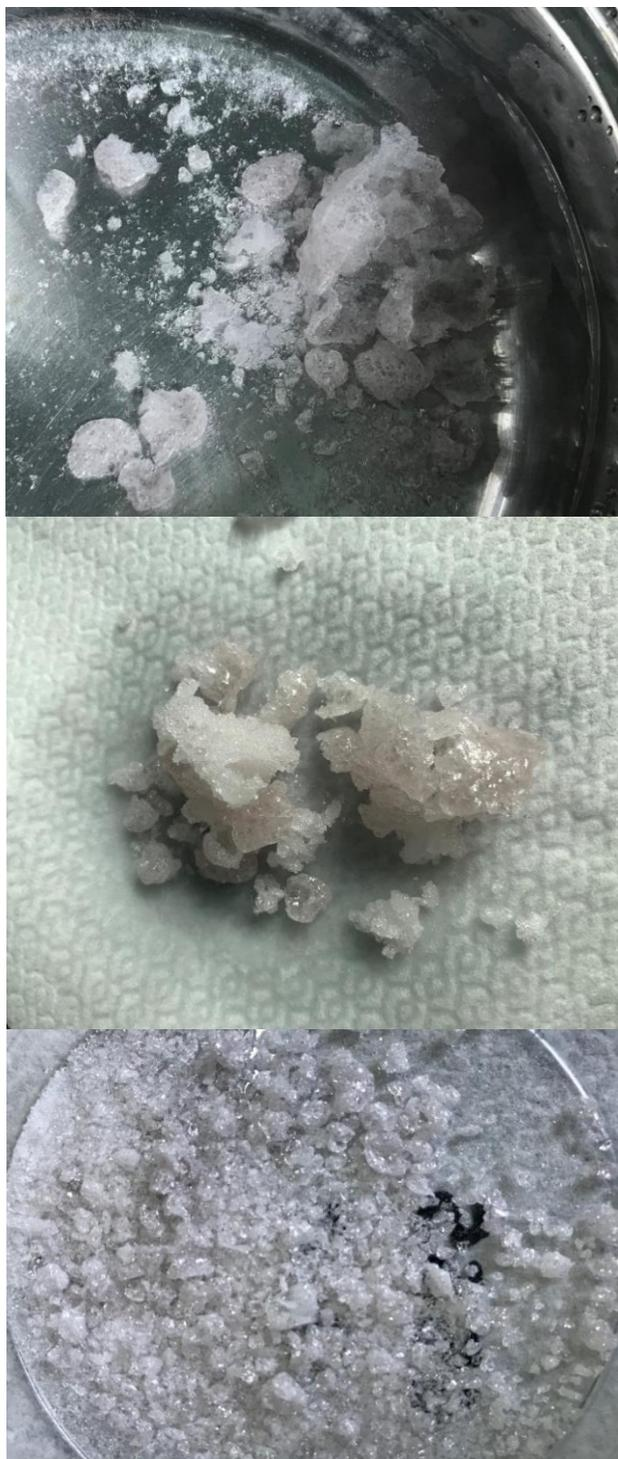
**Figura 7.8:** In alto, vetro 45S5 fuso a 1450 °C scolato in seguito alla colata in acqua a temperatura ambiente. Nel mezzo, il vetro su carta assorbente. In basso, il vetro dopo l'essiccazione in incubatore a 37 °C.
