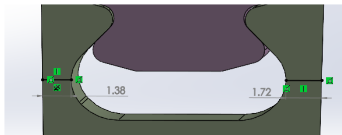
Figura 3.14: Larghezza del rotore nella sezione di gola
