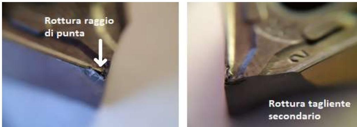
FIGURA 86 ROTTURA DEL DNMG 150608 PR 4415
