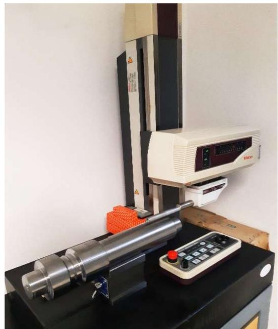
FIGURA 59 RUGOSIMETRO MITUTOYO
