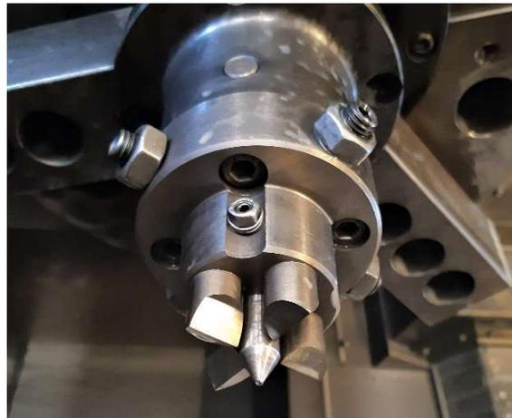
FIGURA 16 DETTAGLIO TRASCINATORE
