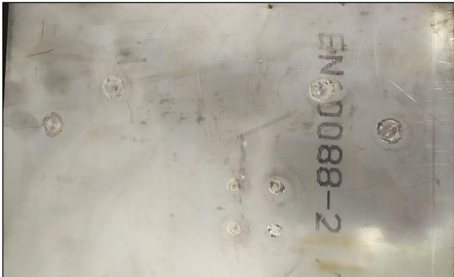
*Figura 45 - Dettaglio saldatura di barre filettate e sopporti sul lato esterno della base in lamiera*
