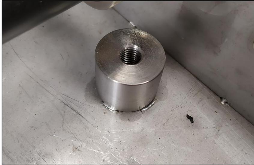
*Figura 44 - Dettaglio saldatura pulsata della boccia per le viti del coperchio, lato interno*
