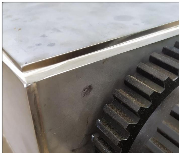
*Figura 21 - Isolamento del coperchio per mezzo di guarnizione piatta in FDA bianco*
