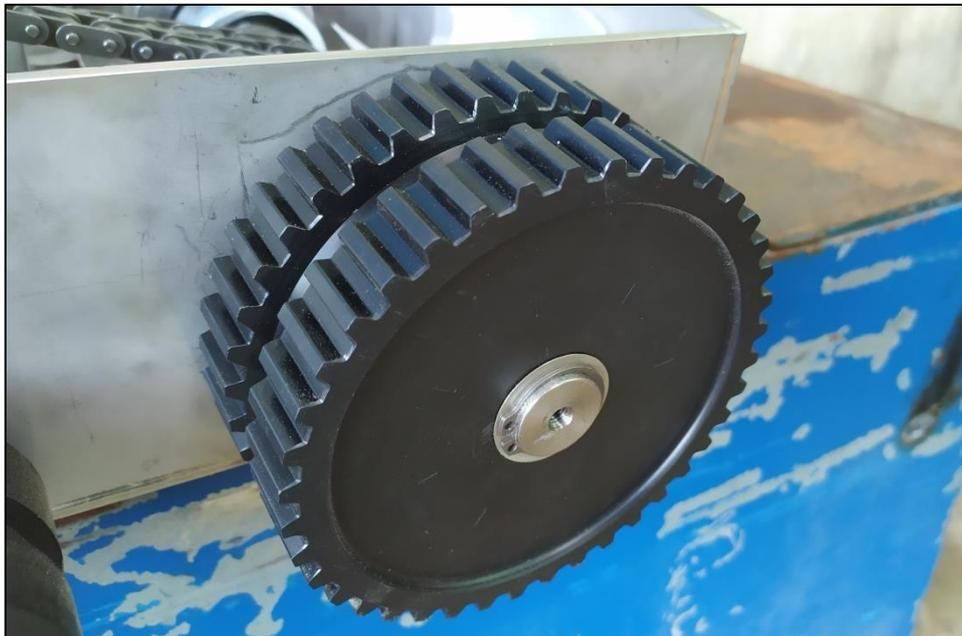
*Figura 25 - Puleggia motrice montata nel robot*
