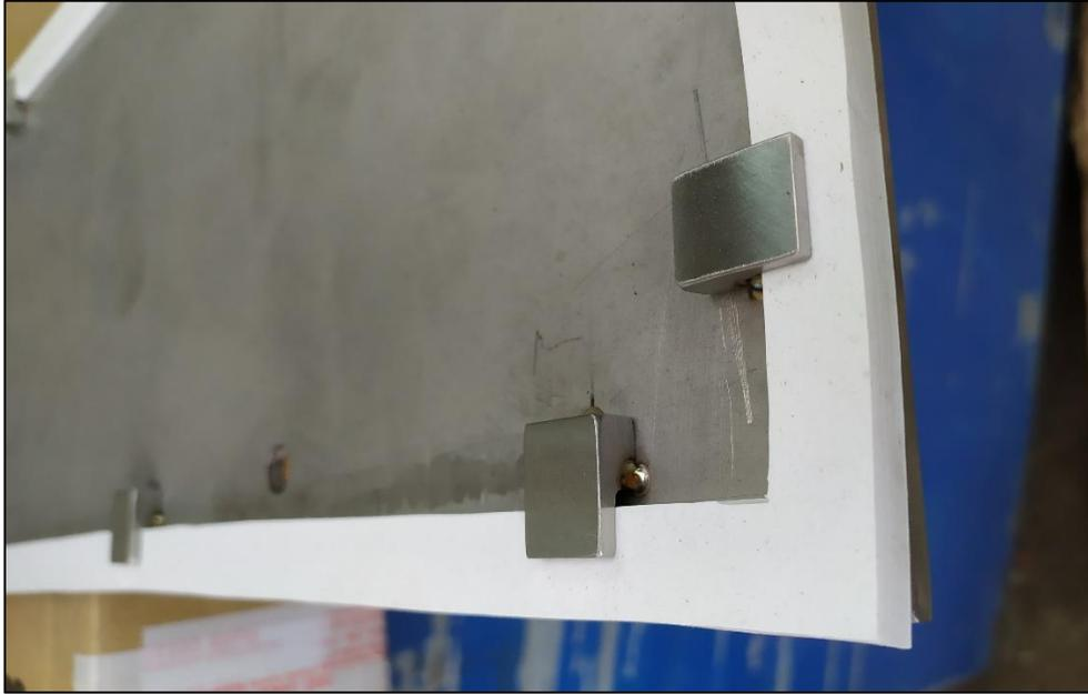
*Figura 22 - Dettaglio bloccaggio della guarnizione del coperchio per mezzo di dentelli*
