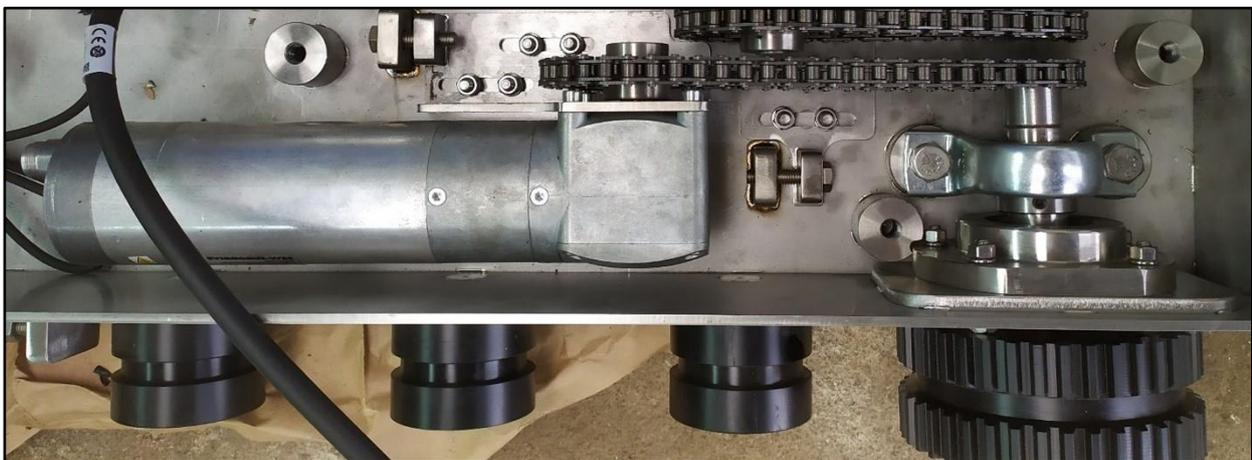
*Figura 10 - Sistema di trasmissione montato*
