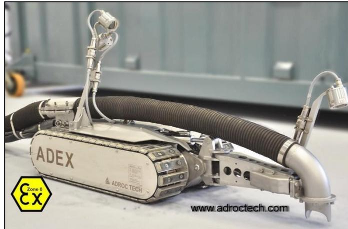
Figura 6 - Robot utilizzato per la pulizia dei serbatoi del settore petrolchimico
