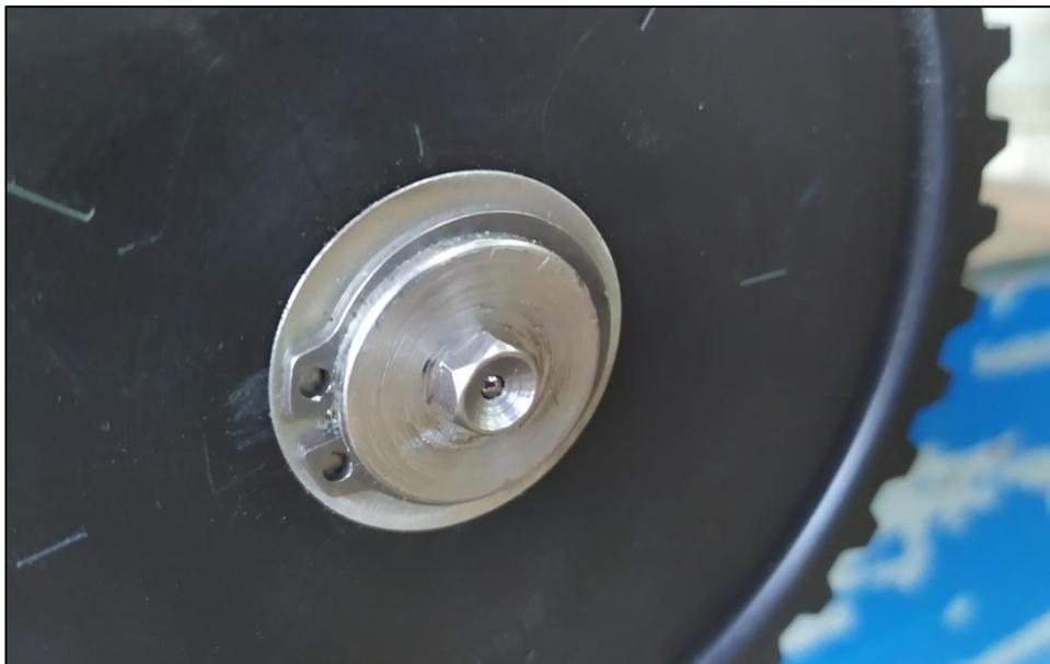
*Figura 39 - Dettaglio del nottolino di lubrificazione montato sull'albero di trazione*
