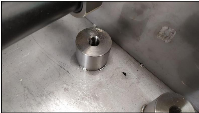
*Figura 20 - Boccole filettate per serraggio delle viti del coperchio*
