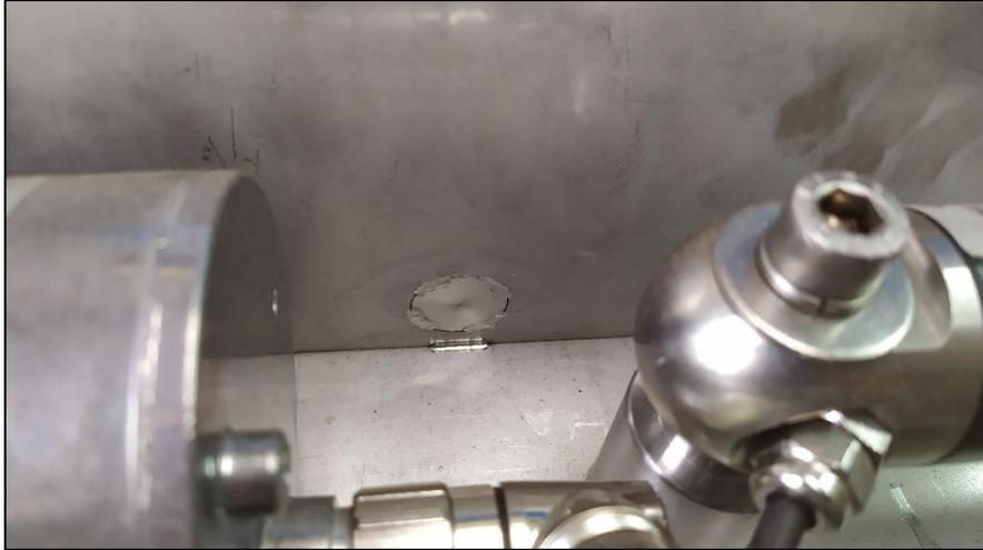
*Figura 42 - Dettaglio saldatura pulsata dell'albero della puleggia folle, sul lato interno*
