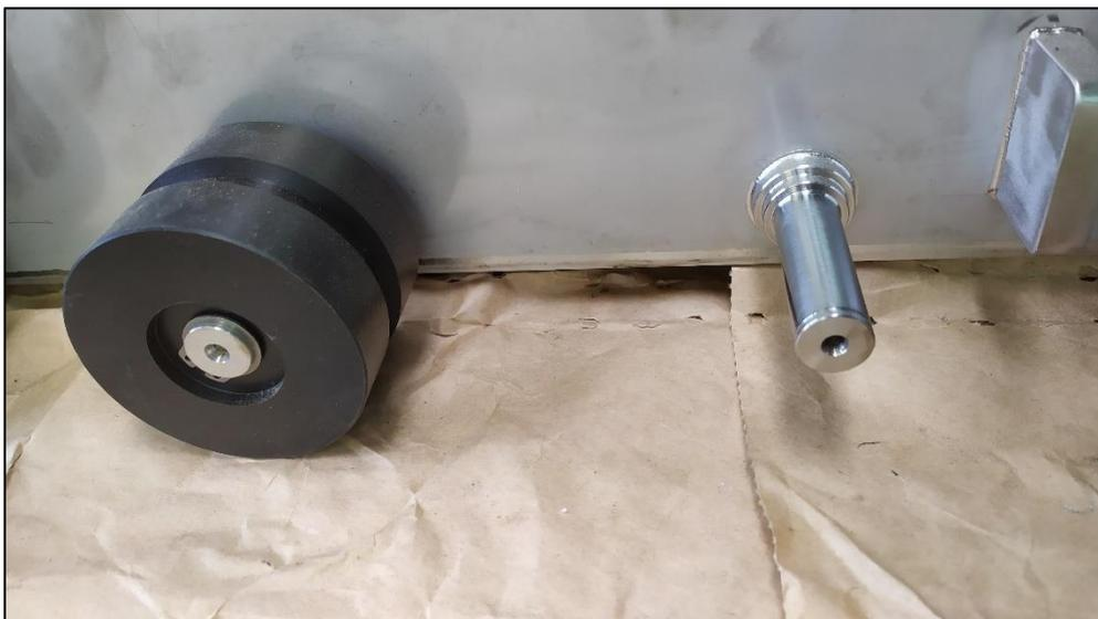
*Figura 30 - Dettaglio degli alberini saldati sulla lamiera laterale, con (sinistra) e senza (destra) puleggia montata*
