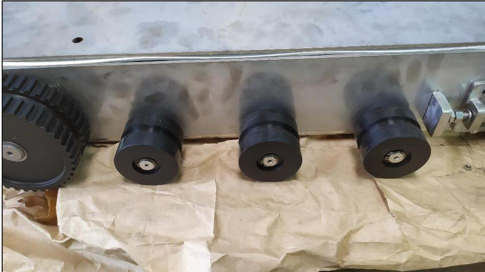
*Figura 29 - Pulegge folli disposte su un lato del robot*
