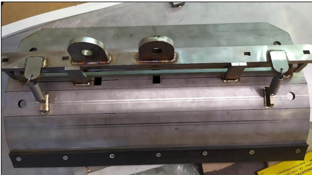
*Figura 16 - Dettaglio sistema di molle per l'inclinazione della pala*
