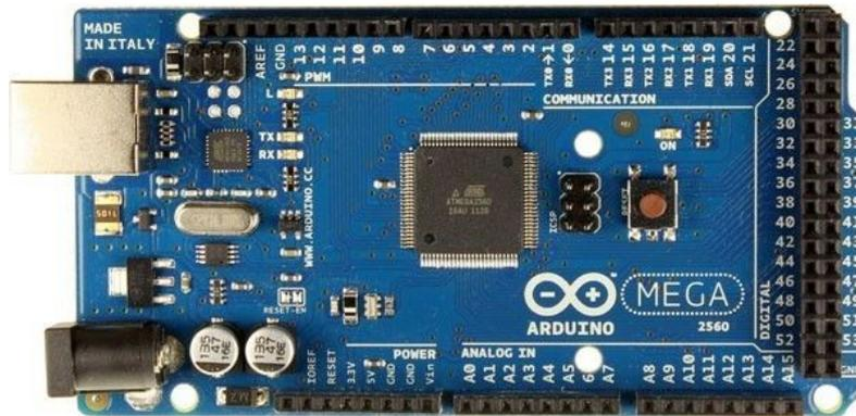
Figura 1.3: Scheda di Arduino Mega
