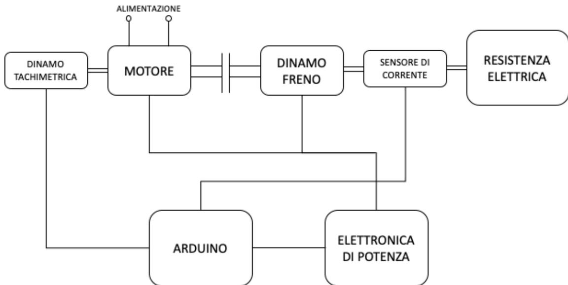
Figura 1.1: Schema del banco prova
