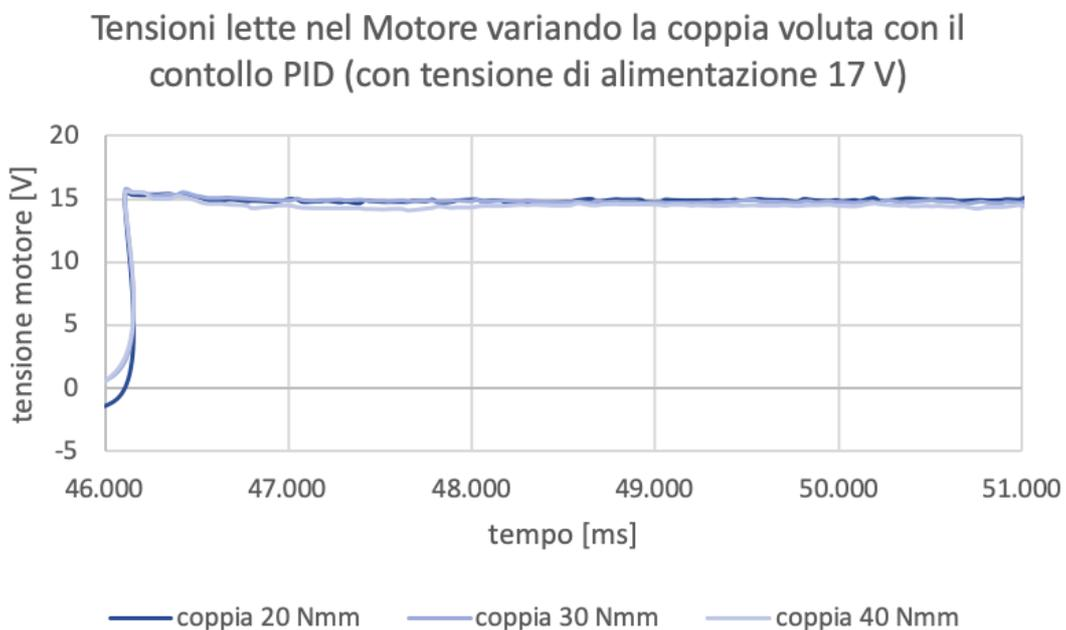
Figura 7.7: Tensioni lette nel Motore variando la coppia voluta con il controllo PID (con tensione di alimentazione fissa di 17 V)
