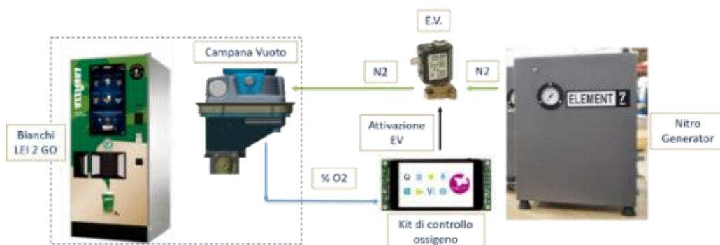
Figura 4.1.1 - Architettura di controllo della %O<sub>2</sub> in campana
