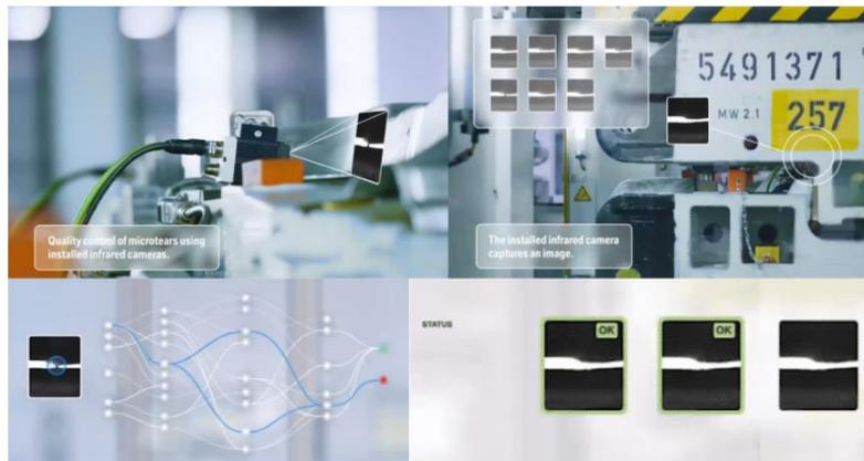
**Figura 4.13:** Impiego del Deep Learning per l'analisi delle immagini eseguite da una telecamera a infrarossi posta nello stampo
