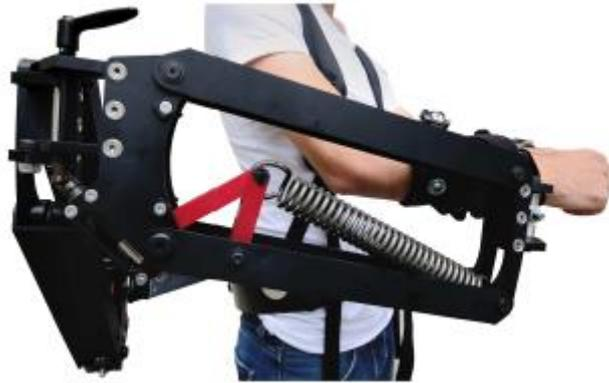
*Figura 4 Modulo parallelogramma passivo Robo-Mate [11]*
