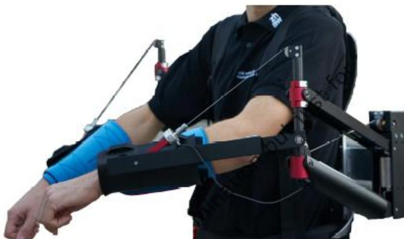
*Figura 5 Modulo parallelogramma attivo Robo-Mate [11]*
