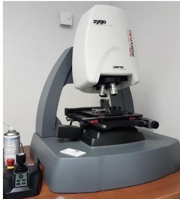
*Figura 3.8: Microscopio interferometrico a scansione*
