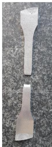
*Figura 4.49: Provino utilizzato durante la prova di trazione*
