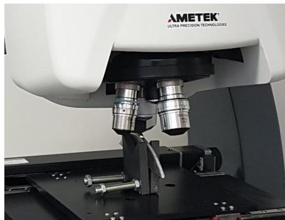
*Figura 4.20: Acquisizione superficie di tranciatura*
