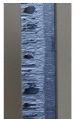
*Figura 4.28: Profilo di tranciatura con riferimento alla superficie da cui viene ricavato*
