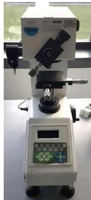
*Figura 3.6: Microdurometro*
