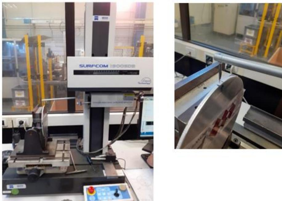
*Figura 4.27: Acquisizione del profilo sulla superficie di tranciatura*
