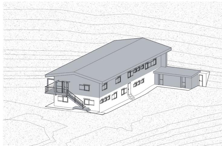
Demolizione del primo piano, locale impianti e legnaia e scalal esterna
