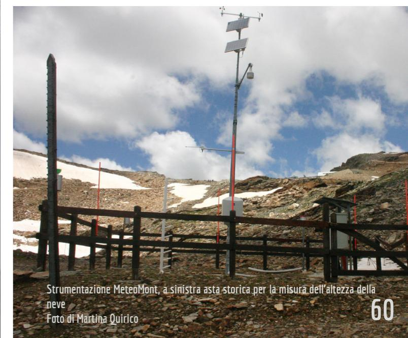
Strumentazione MeteoMont, a sinistra asta storica per la misura dell'altezza della neve
