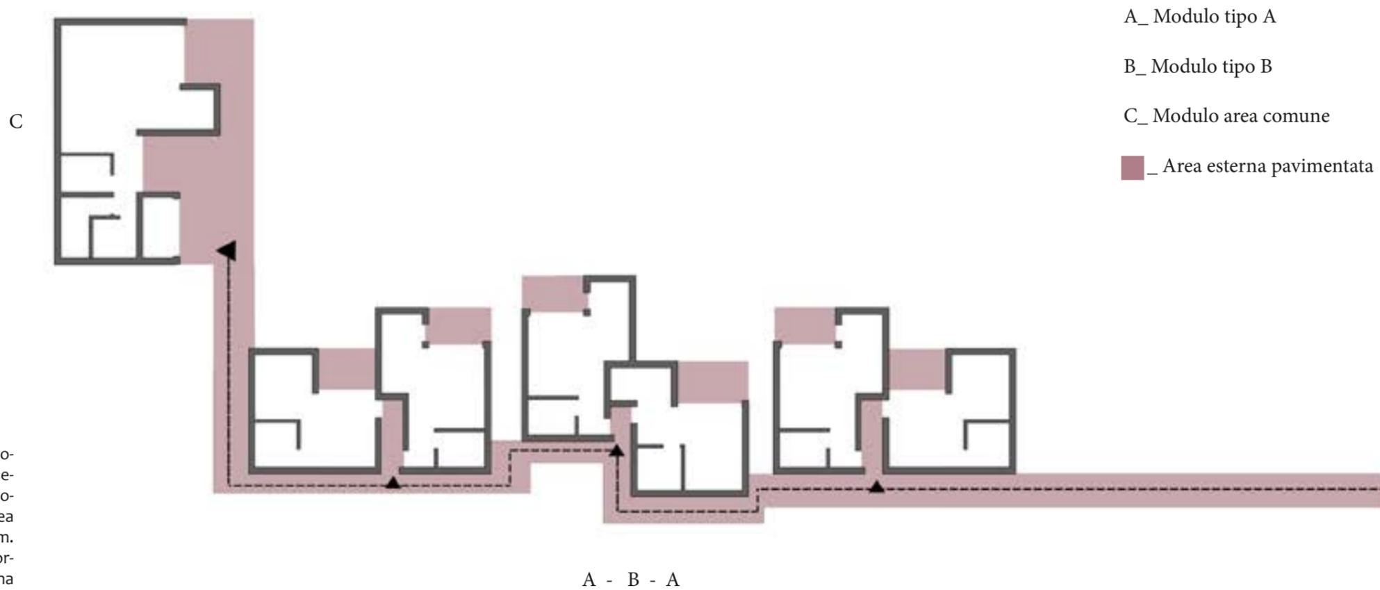
Fig.6.6.1 Disposizione dei moduli *a* e *b* secondo la combinazione prevista per l'area archeologica di Peltuinum. Viene evidenziata la trasformazione dell'area esterna in base alla combinazione delle strutture modulari.
