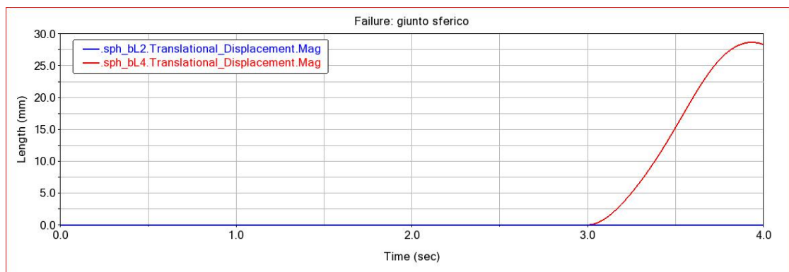
Figura 5.19: Andamento traslazione del giunto sferico in failure
