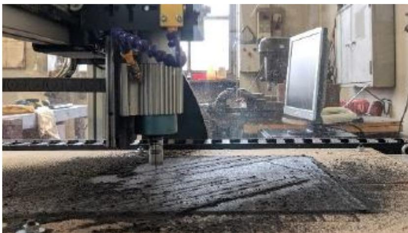
Figura 7.10: Preparazione provini in laminato
