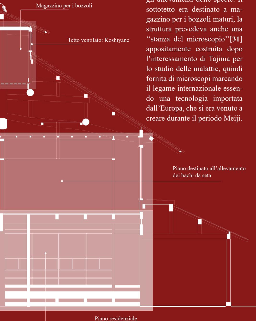
Figura 8. Sezione in scala dell'edificio principale dell'azienda di Tajima Yahei.
