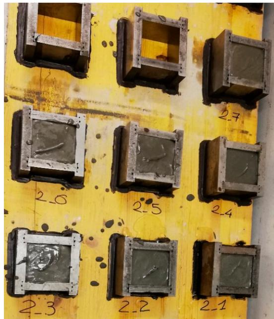
Figura 2.55 Specimen filling - serie #2
