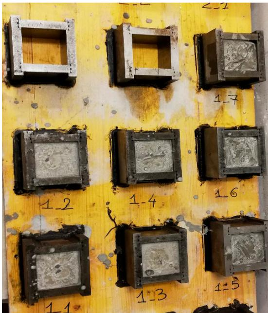
Figura 2.54 Specimen filling - serie #1
