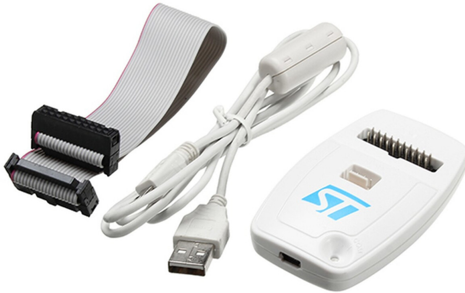
Figura 3.4. Il debugger ST-LINK/V2 con i suoi connettori USB e JTAG.
