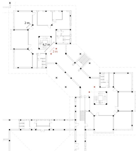
Figura 82. Stralcio della pianta piano terra dei corpi avanzati e arretrati. In evidenza, i pilastri strutturali aggiuntivi dello scheletro portante.
