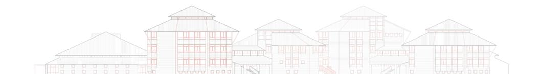
Figura 72. Prospetto est, configurazione attuale. In rosso, le trasformazioni avvenute
