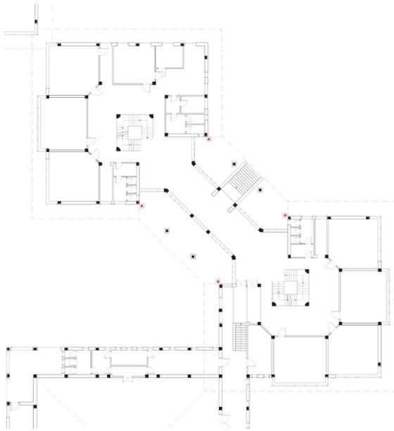
Figura 87. Stralcio di pianta piano terra. In evidenza in rosso, i pilastri strutturali inseriti a sostegno dello sporto della galleria, in seguito ai problemi di natura statica.
