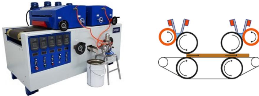
**Figura 1.8:** Esempio di Roller Coater e schema di funzionamento [9].
